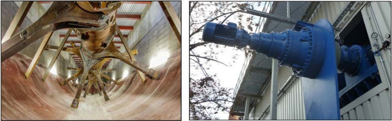
Fig.18.: Particolari degli organi di movimentazione interni del digestore, di tipo longitudinale (in alto) o trasversale (in basso), a seconda del costruttore
