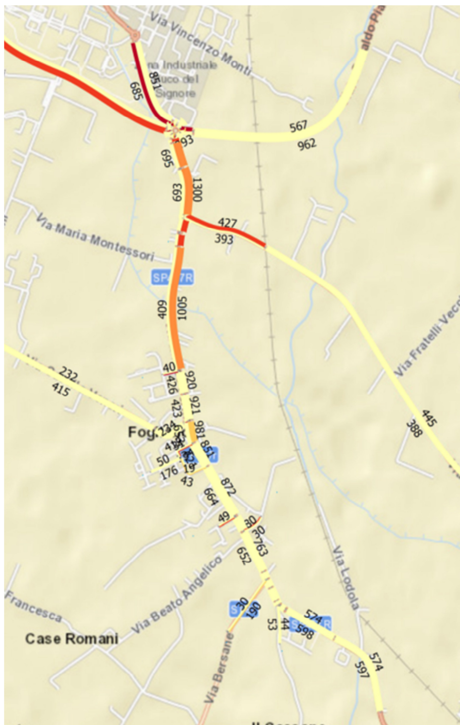
Stato di fatto – Flussogramma dell'ora di punta del mattino riportante i flussi veicolari (etichette) e il grado di congestione (colore)
