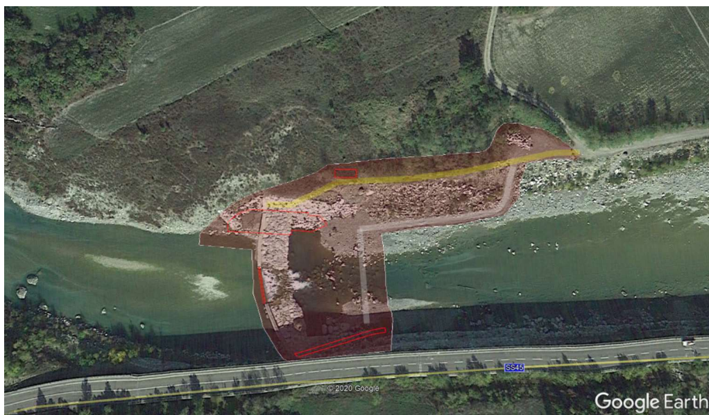
Figure 1 – Ortofoto con indicazione dell'area di cantiere complessiva prevista (rosso). La linea gialla rappresenta la pista di cantiere principale (che al termine dei lavori verrà convertita in pista di accesso definitiva); la linea bianca rappresenta una pista di cantiere secondaria, necessaria per le operazioni in alveo e per la realizzazione della scala per pesci.
