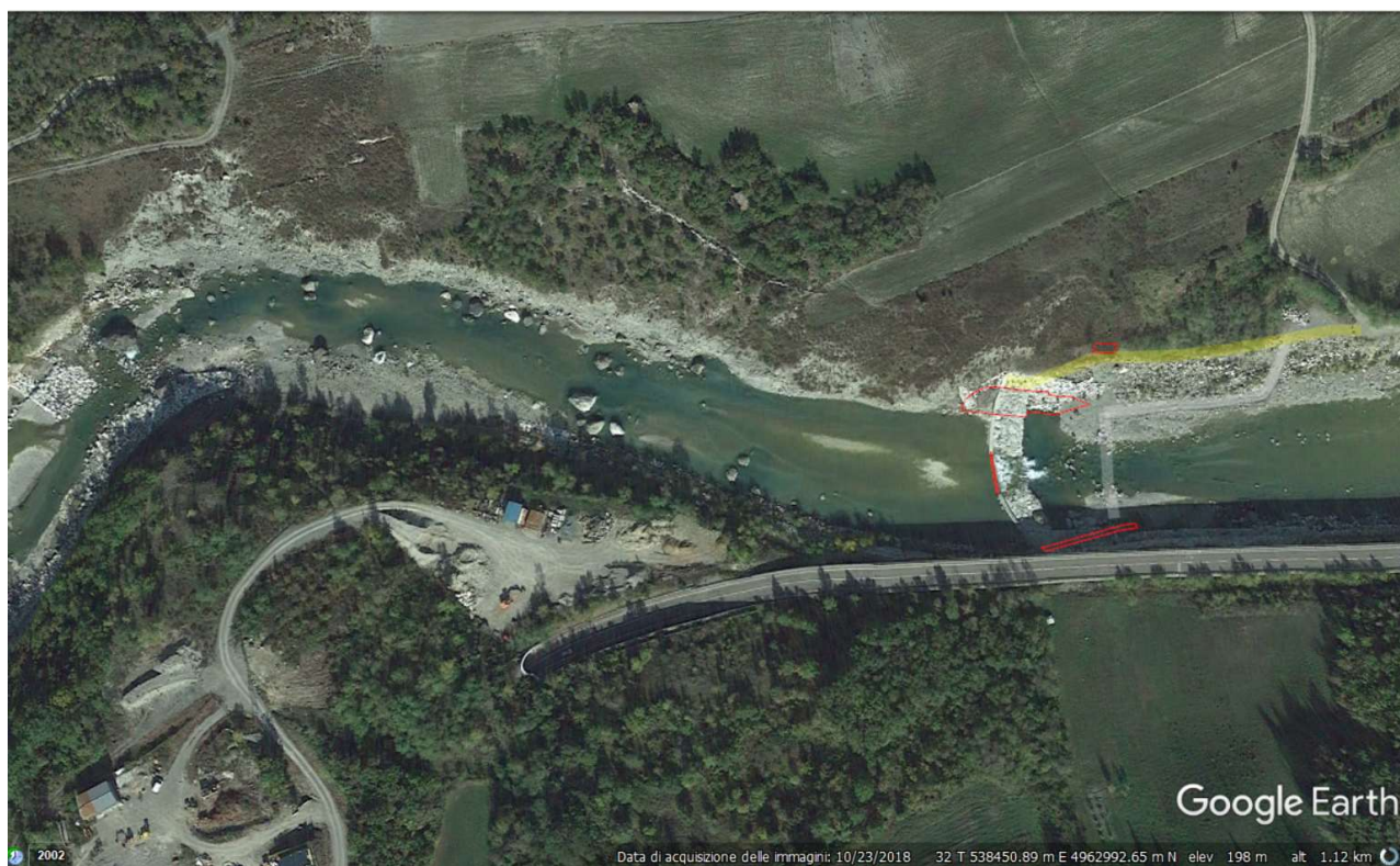
Figura 7 – Estratto ortofoto dell'area oggetto di rilievo. In rosso si riportano i perimetri delle opere in progetto; la linea gialla rappresenta la pista di accesso.
