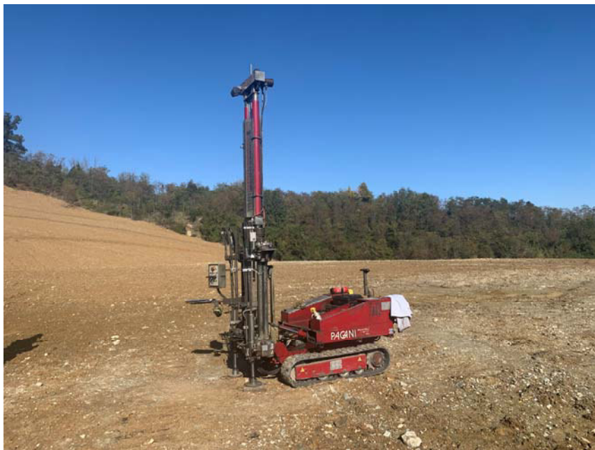
Particolare fotografico del penetrometro utilizzato
