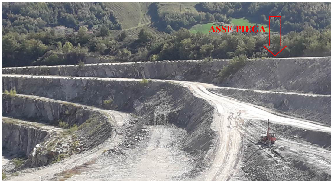
Fotografia 8.2: individuazione dell'asse della piega individuata nel cantiere Albarola.
