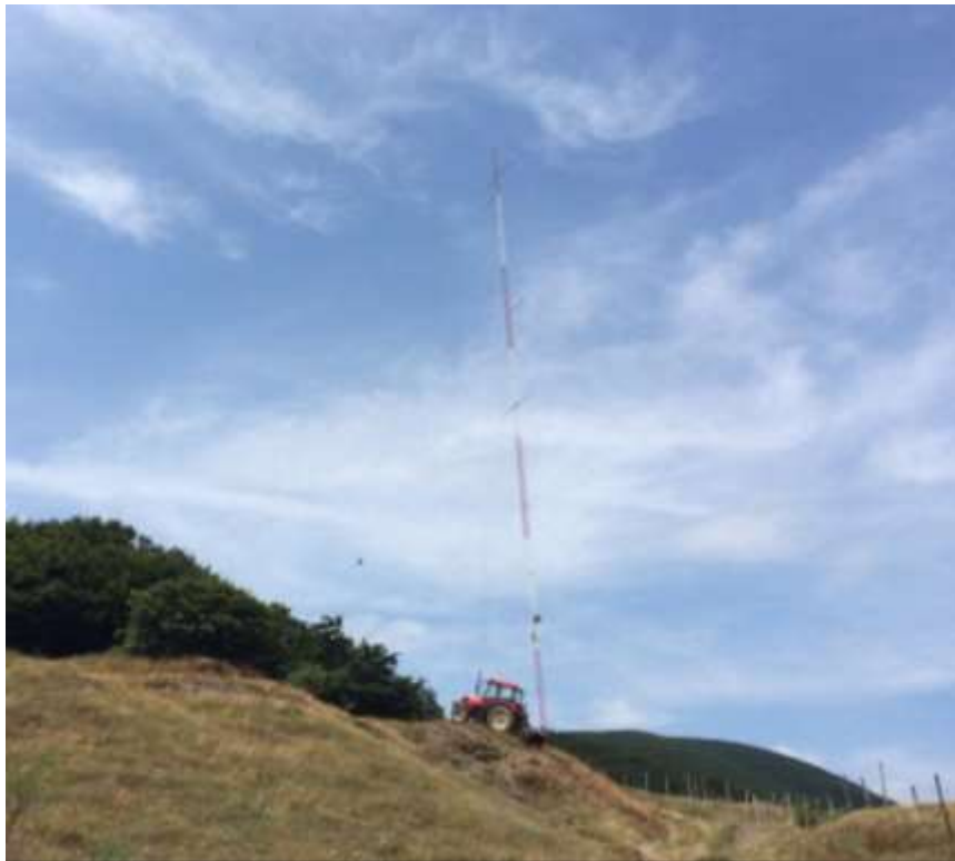
Figura 2.1 – Stazione anemometrica di tipo tralicciato per la rilevazione del vento.
