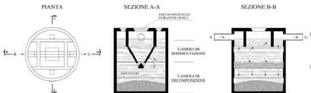
Figura 4.1: schema di montaggio fossa IMHOF
