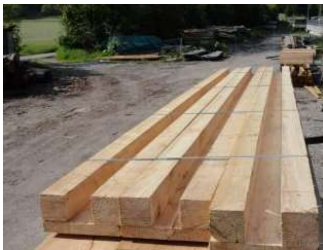
Figura 5.5: esempio di canalette in larice per la realizzazione del drenaggio superficiale.
