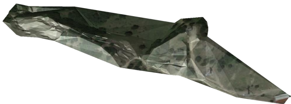
FIGURA 2_MODELLO TRIDIMENSIONALE DEL TERRENO VALUTATO DA RILIEVO 3D IN SITO
