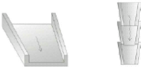
FIGURA 5: ESEMPIO DI ELEMENTI IN CALCESTRUZZO PREFABBRICATO DA POSARSI ALL'INTERNO DELLE CANALETTE DI SCOLO
