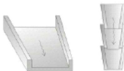
Figura 5.10: esempio di elementi in calcestruzzo prefabbricato da posarsi all'interno delle canalette di scolo
