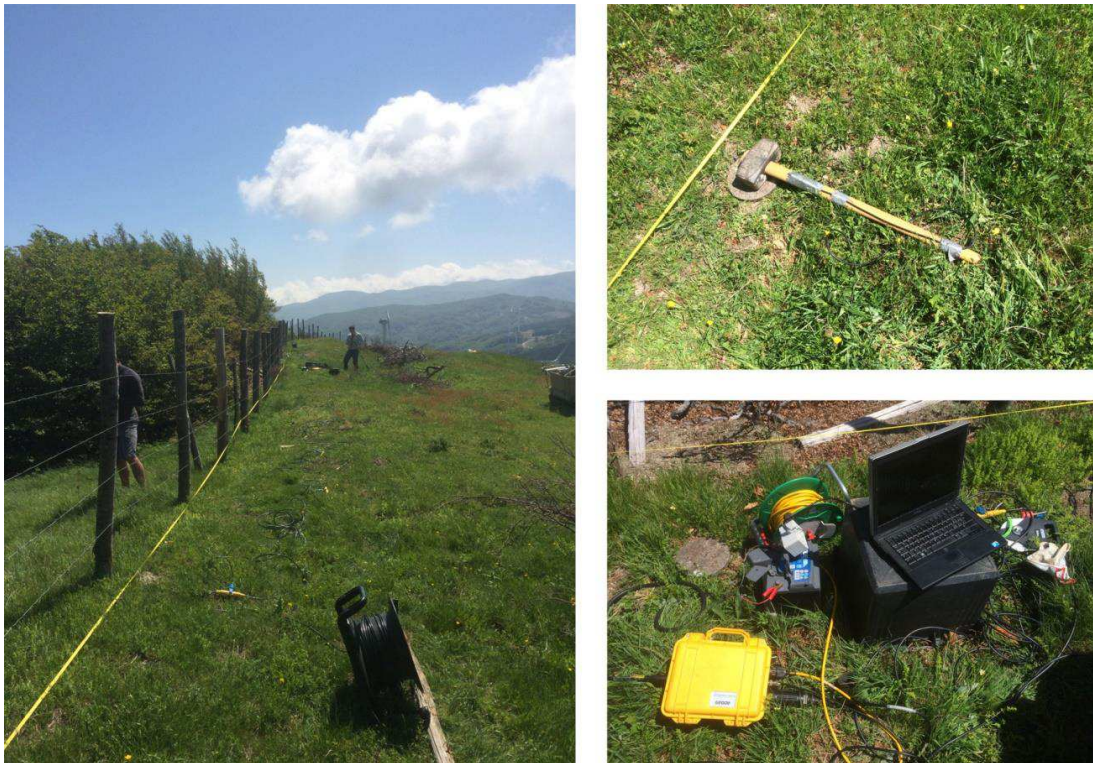
Figura 2 Profilo sismico e apparati per la generazione e l'acquisizione delle onde P.
