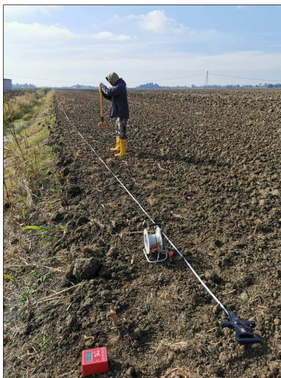
Figura 8.4. Esecuzione prove sismiche: MASW 1 (sinistra) e HVSR 1 (destra)
