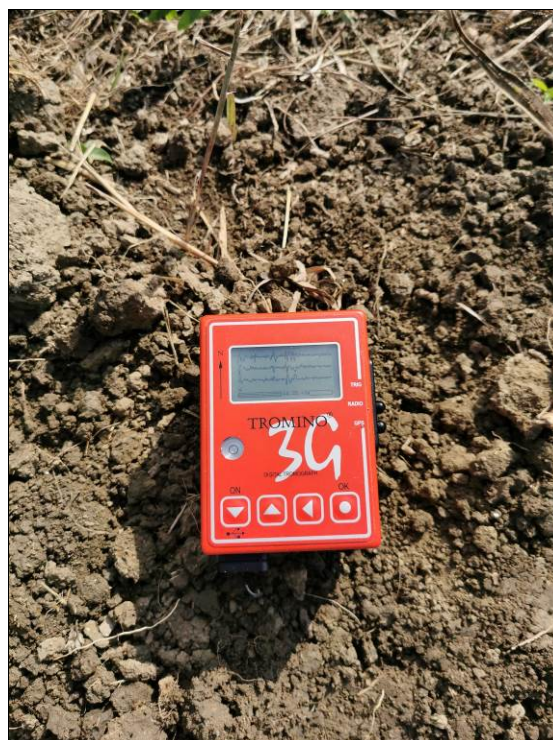
Figura 8.4. Esecuzione prove sismiche: MASW 1 (sinistra) e HVSR 1 (destra)
