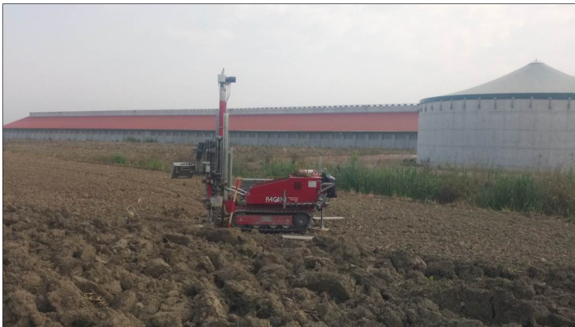
Figura 8.3. Esecuzione prova CPTU 5, CPTU 3 e prove sismiche MASW e HVSR
