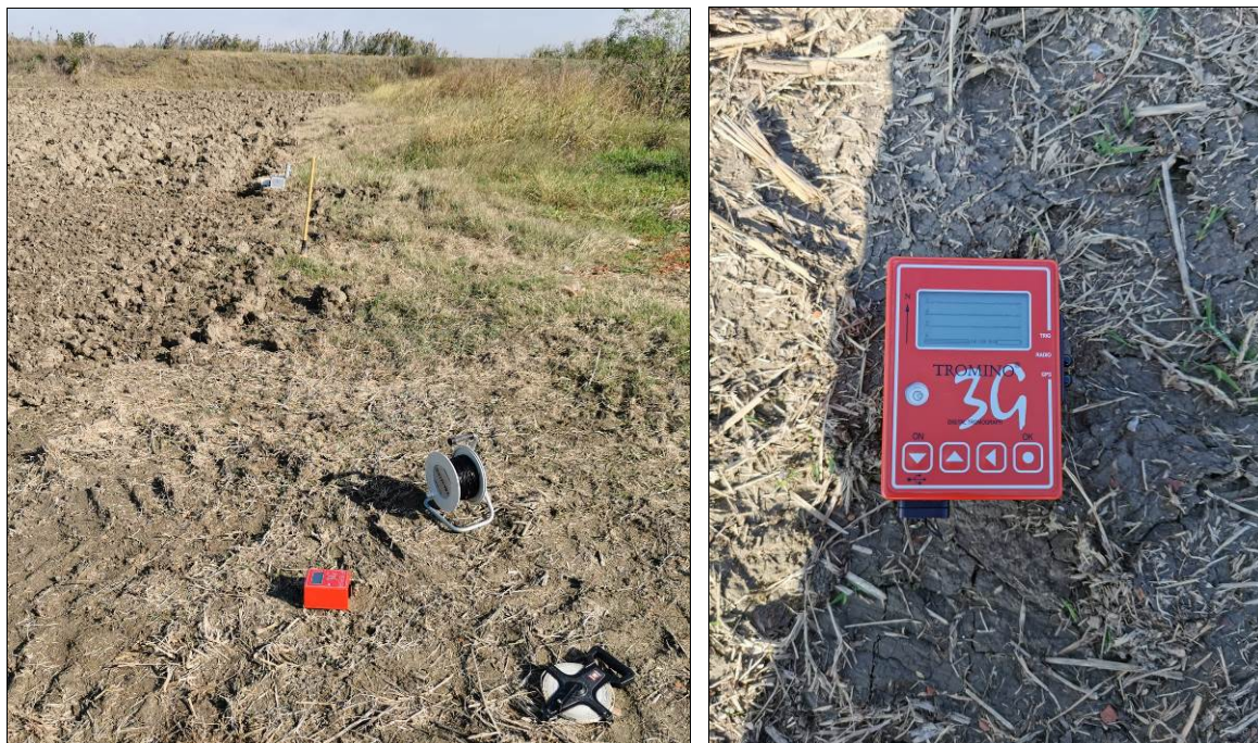
Figura 8.5. Esecuzione prove sismiche: MASW 2 (sinistra) e HVSR 2 (destra)
