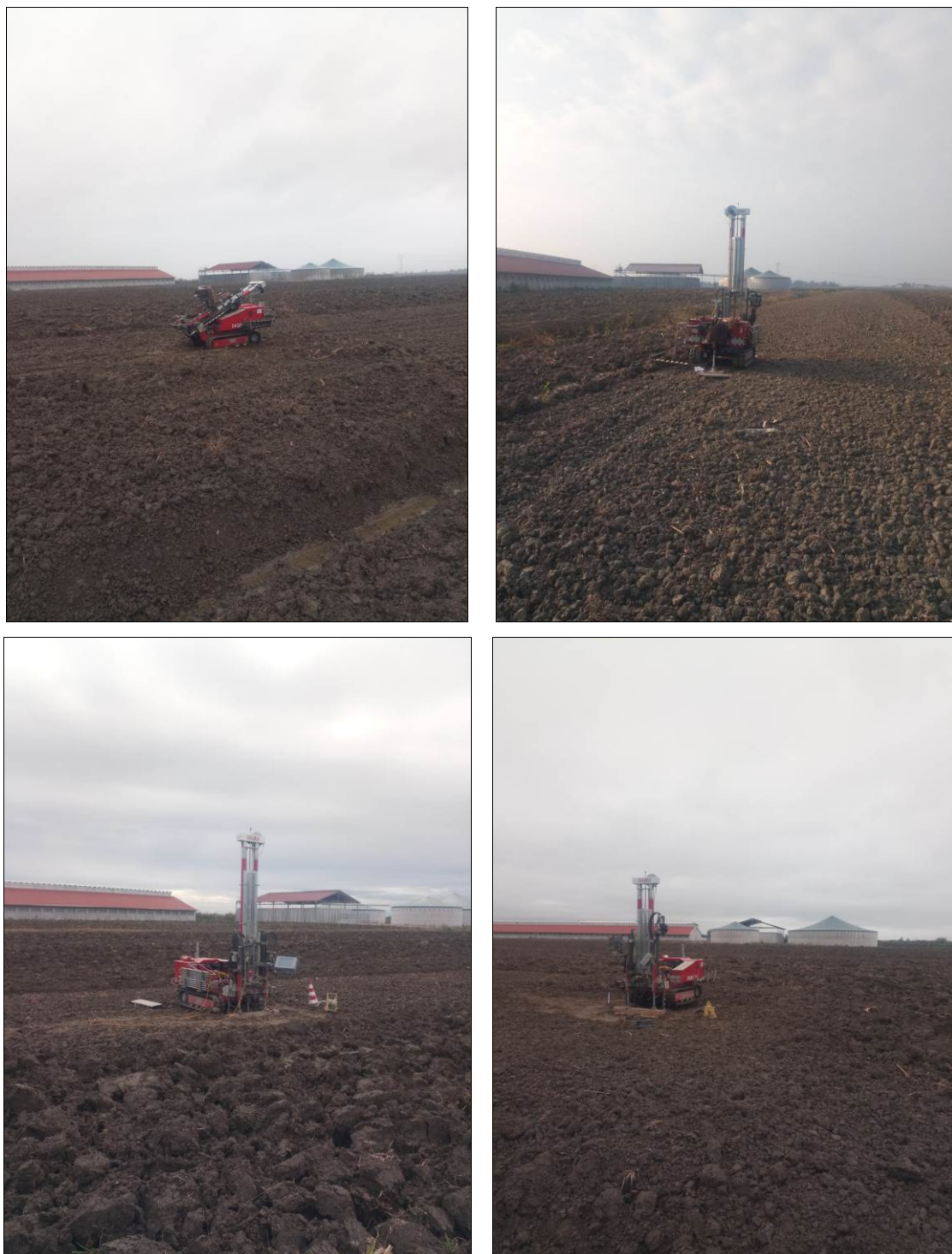
Figura 8.2. Da sinistra a destra e dall'alto in basso. Esecuzione prova CPTU 1, CPTU 2, CPTU 3 e CPTU 4
