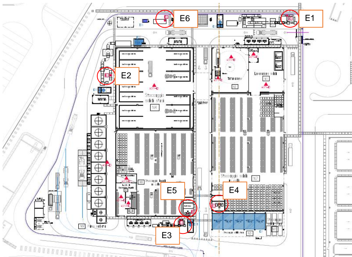
Figura 45 - Posizione emissioni convogliate E1, E2, E3, E4, E5 ed E6 (stralcio elaborato AIA 03.01 CO 05 RA AA 00 DT PL 03.01 – Allegato 3A alla domanda di AIA: Planimetria Emissioni)
