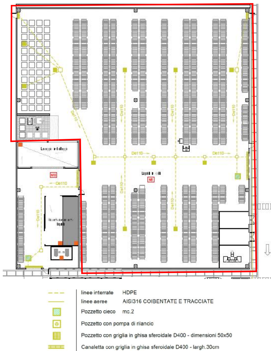
Figura 29 – Dettaglio rete di drenaggio sezione N8 (stralcio elaborato CO 05 RA AA 00 DT PL 03.02 – Allegato 3B – Planimetria dell'impianto (rete idrica))
