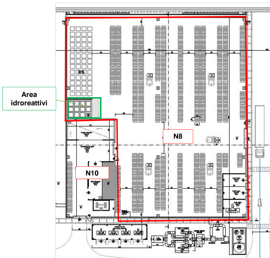
Figura 27 - Dettaglio localizzazione (in rosso) della Sezione N8 e della relativa area idroreattivi (in verde)(stralcio elaborato EI.48.00_CO 05 RA VA 00 D1 PL 48.00 - N8-N10 PIANTE)
