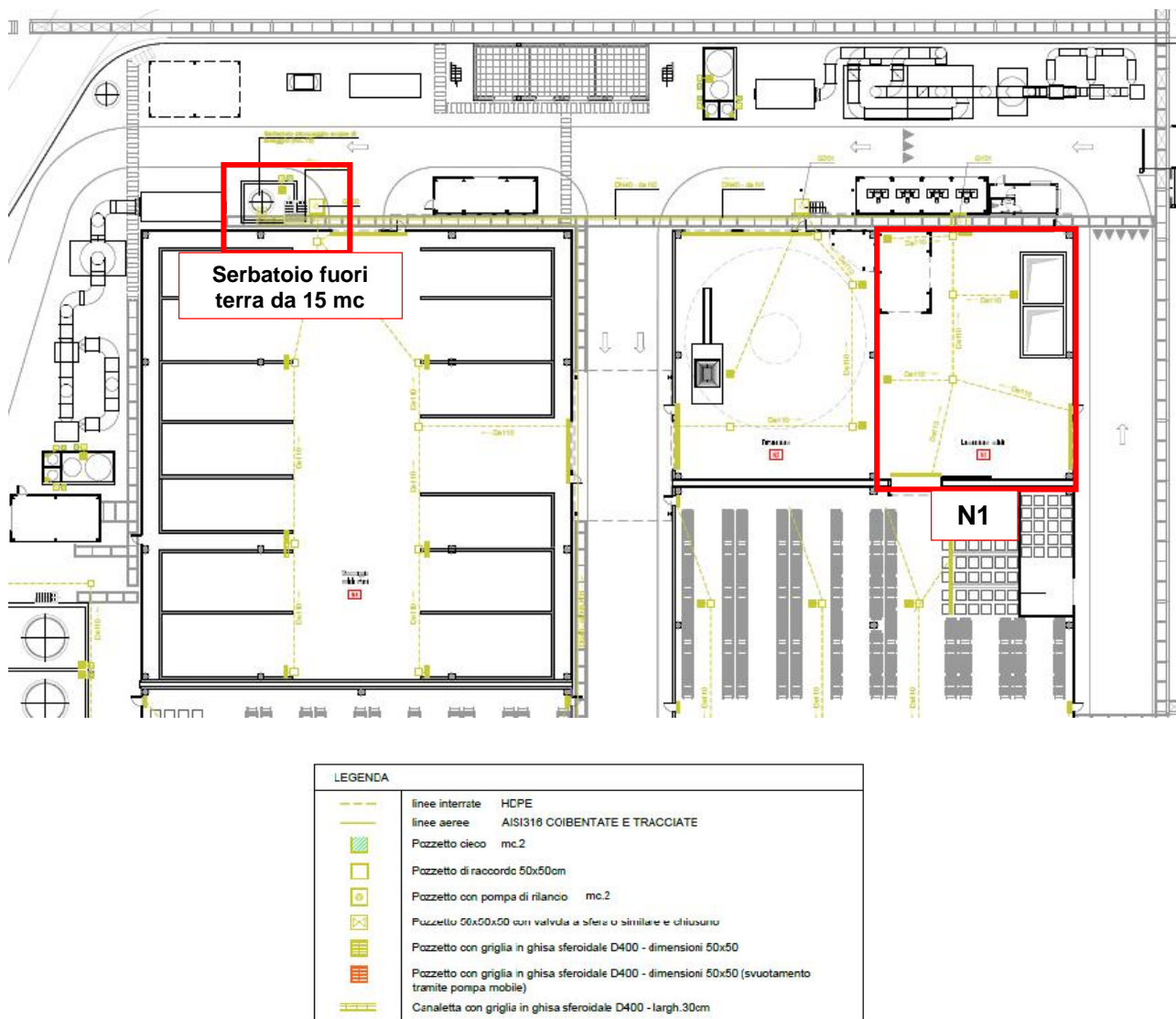
Figura 11 - Dettaglio rete di drenaggio sezione N1 e serbatoio di raccolta fuori terra (stralcio elaborato CO 05 RA AA 00 DT PL 03.02 – Allegato 3B – Planimetria dell'impianto (rete idrica))
