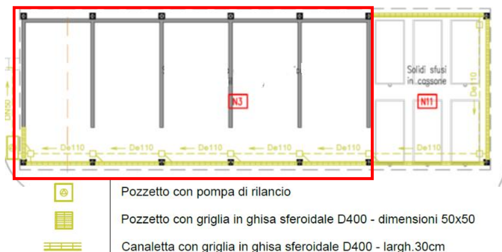
Figura 19 – Dettaglio rete di drenaggio sezione N3 ed N11 (stralcio elaborato CO 05 RA AA 00 DT PL 03.02 – Allegato 3B – Planimetria dell'impianto (rete idrica)
