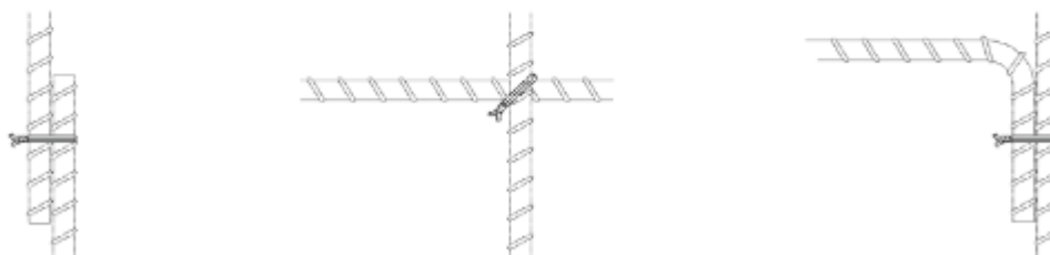
Figura E.5c – Legatura (Idonea per correnti di fulmine e per EMC)
