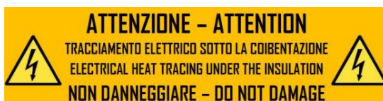
Figura 5 - Etichetta di identificazione linea elettricamente tracciata
