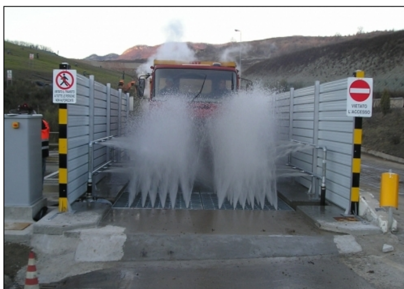
Figura 3- Impianto lavaggio ruote
