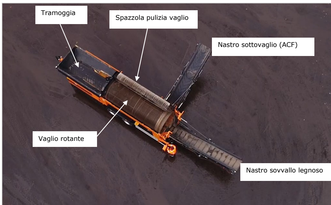
Figura 7: Descrizione vaglio mobile
