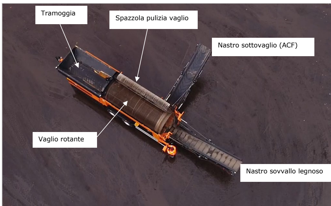
Figura 27: Descrizione vaglio mobile
