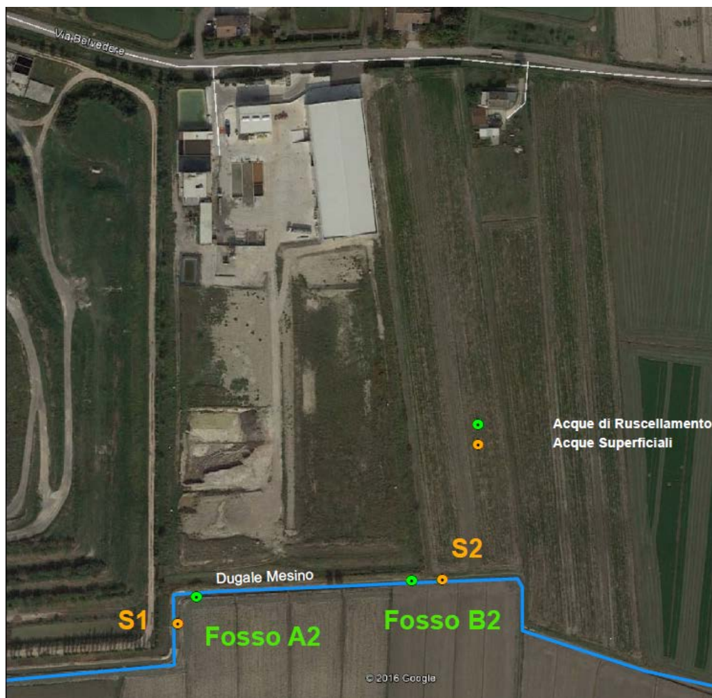
Figura 27 - Planimetria con rete di monitoraggio delle acque superficiali e meteoriche di ruscellamento
