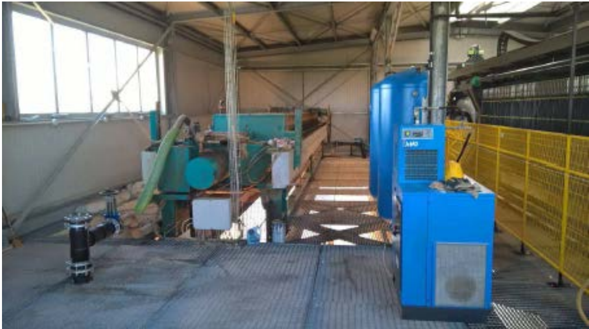
Figura 11 Dettaglio della sorgente S3 (le due filtropresse, a sinistra la vecchia, a destra la nuova GHT 1500).
