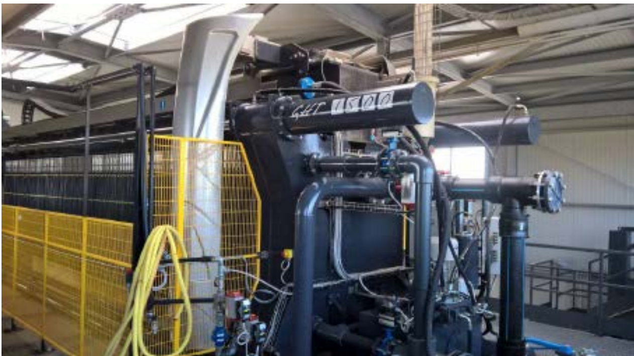
Figura 12 Dettaglio della sorgente S3: la nuova filtropressa GHT 1500.
