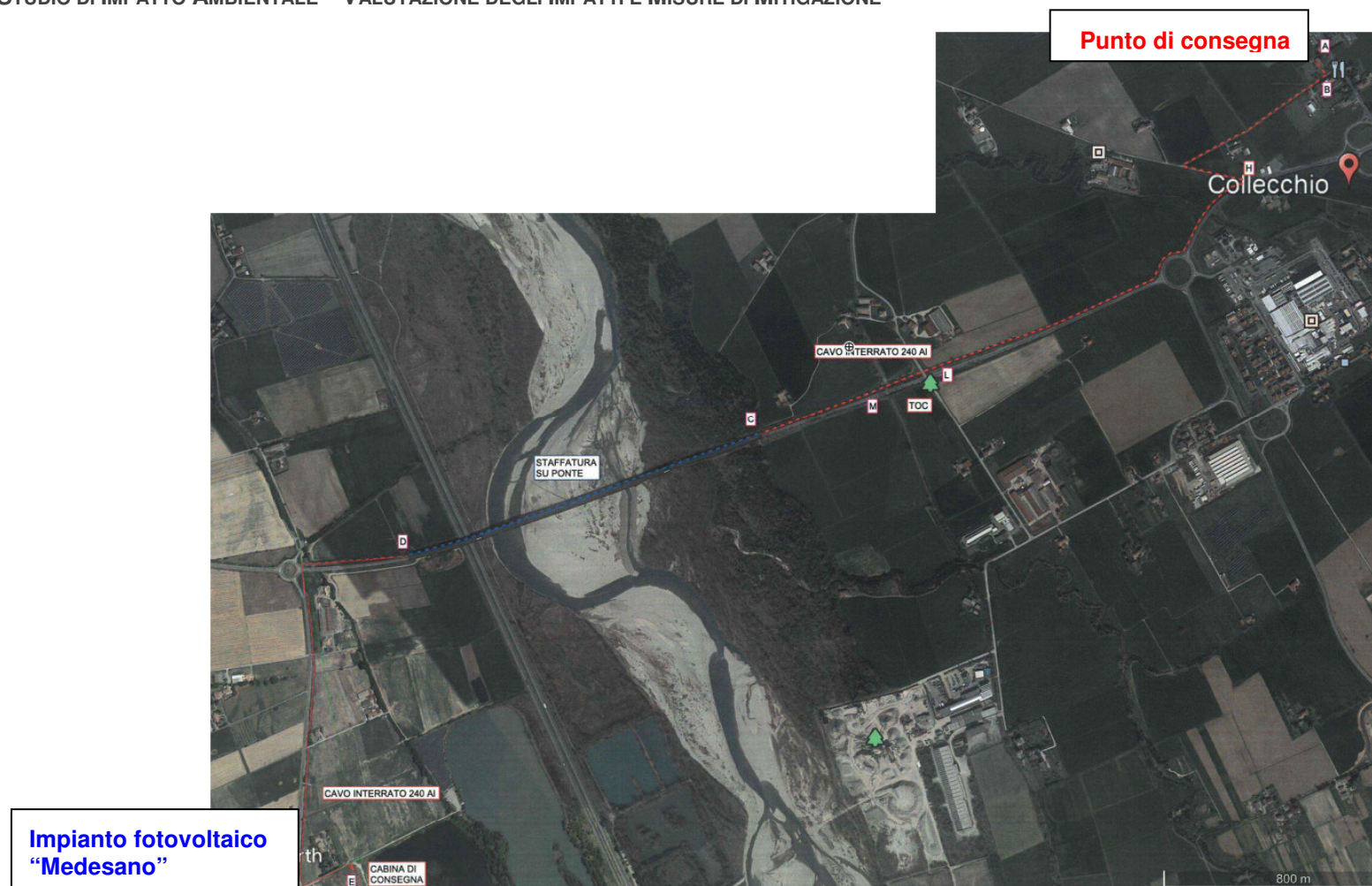
Figura 2.3.3 – Foto aerea con evidenziate la definitiva alternativa di connessione dell'impianto fotovoltaico alla cabina di consegna prevista da E-Distribuzione per l'attraversamento del F. Taro con cavo agganciato alla struttura del ponte stradale esistente.
