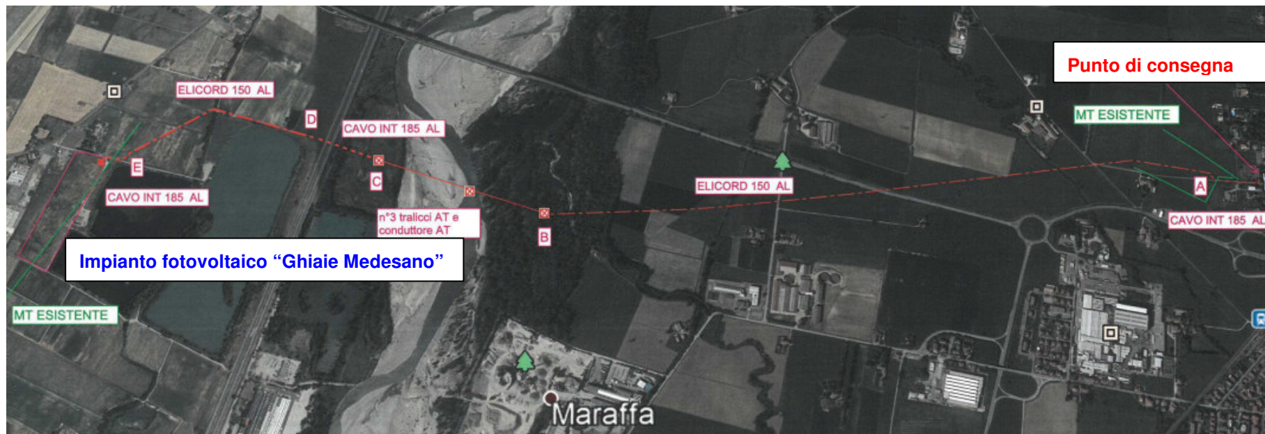
Figura 2.3.2 – Foto aerea con evidenziate la prima alternativa di connessione dell’impianto fotovoltaico alla cabina di consegna prevista da E-Distribuzione per l’attraversamento del F. Taro con cavo aereo.
