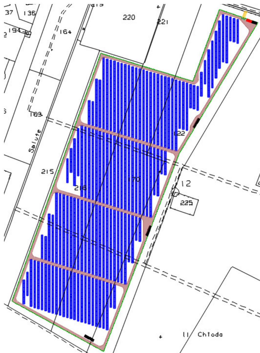
Figura 4.2.4 – Planimetria dell'area in cui si evidenzia la presenza di corsie sufficientemente larghe da consentire il transito di piccoli autoveicoli per l'eventuale manutenzione.
