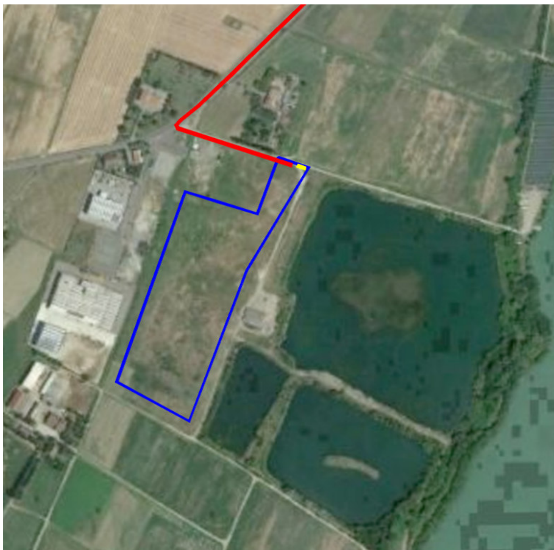
Figura 2.3.1 – Ipotesi della soluzione tecnica minima fornita da E-Distribuzione a seguito richiesta preventivo per STMG (fuori scala). In giallo la cabina di consegna dell'impianto.
