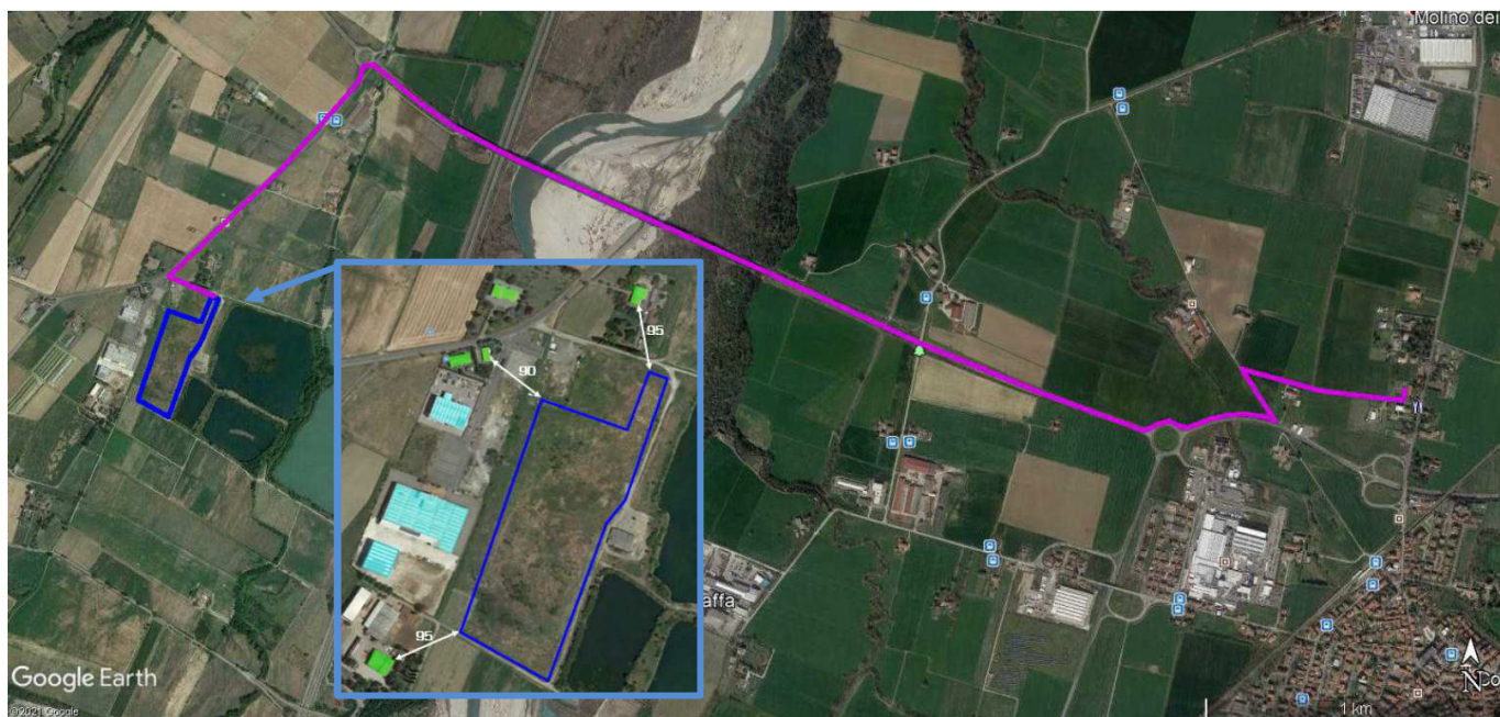
Figura 3.2.1 – Area limitrofa alla sede di installazione dell’impianto fotovoltaico e tracciato della linea elettrica interrata di connessione alla rete. Perimetro dell’impianto in colore blu, linee MT di distribuzione in colore viola, civili abitazioni in colore verde, altre attività produttive in colore azzurro.
