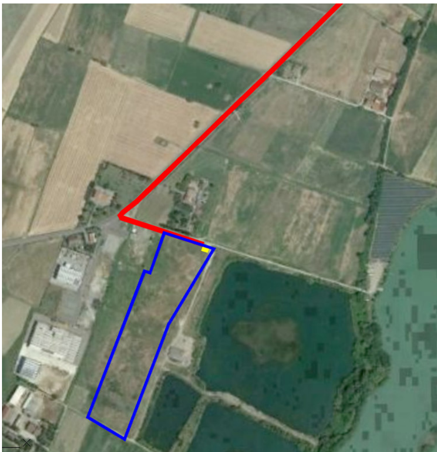
Figura 5.1.6 – Ipotesi della soluzione tecnica minima fornita da E-Distribuzione a seguito richiesta preventivo per STMG (fuori scala). In giallo la cabina di consegna dell'impianto.
