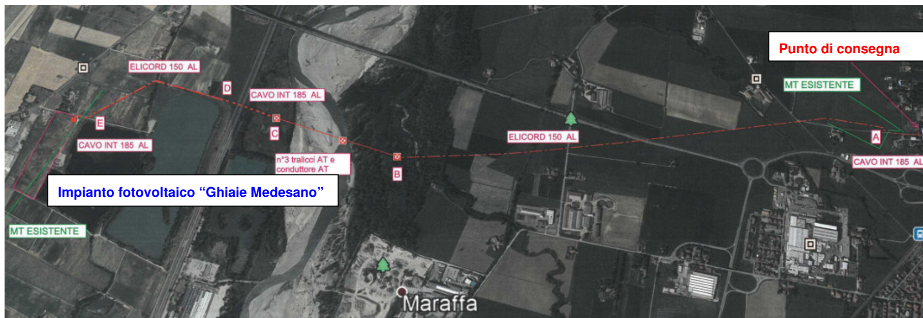
Figura 5.1.7 – Foto aerea con evidenziate la prima alternativa di connessione dell’impianto fotovoltaico alla cabina di consegna prevista da E-Distribuzione per l’attraversamento del F. Taro con cavo aereo.
