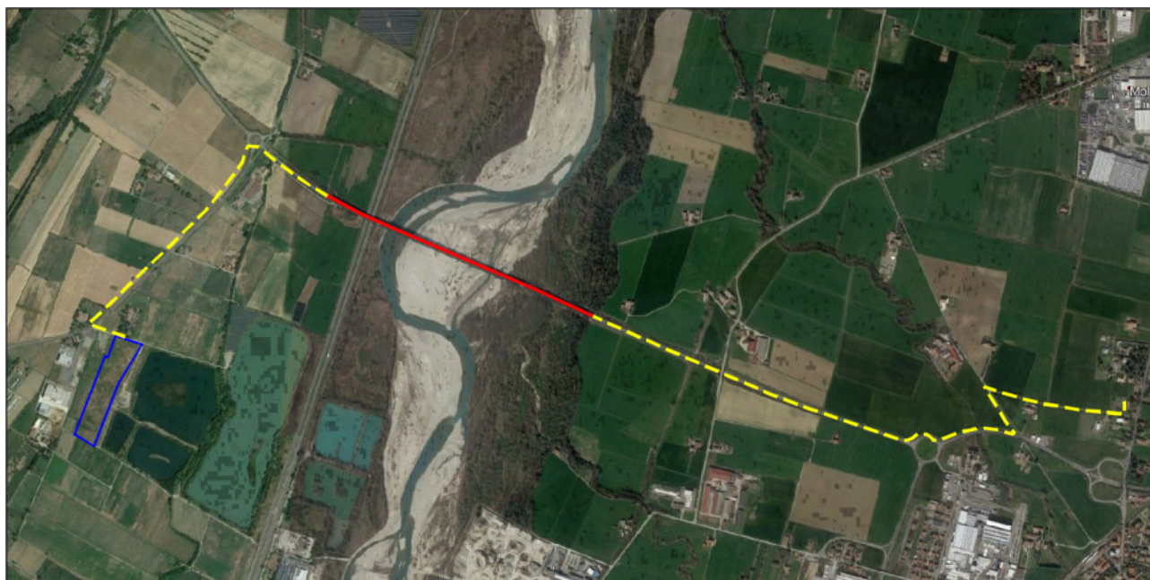
Figura 4.1.1 – Inquadramento dell'area di intervento su foto aerea (Fonte Google earth, immagine del 18/03/2020). In blu l'area in cui si prevede la realizzazione dell'impianto fotovoltaico, in giallo il tracciato della linea elettrica di connessione interrato, in rosso il tracciato della linea staffata alla struttura del ponte esistente.
