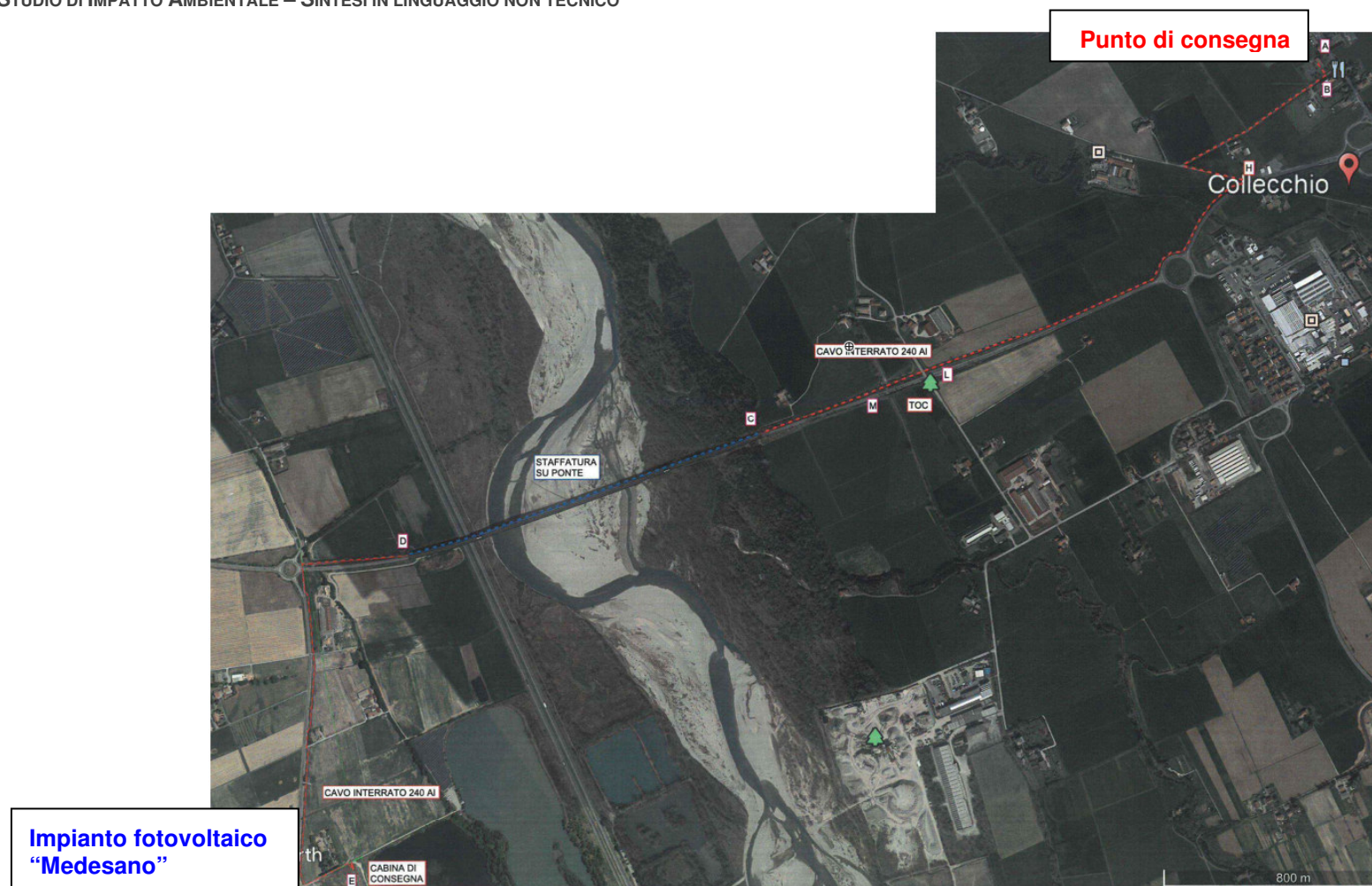
Figura 5.1.8 – Foto aerea con evidenziate la definitiva alternativa di connessione dell’impianto fotovoltaico alla cabina di consegna prevista da E-Distribuzione per l’attraversamento del F. Taro con cavo agganciato al ponte esistente.
