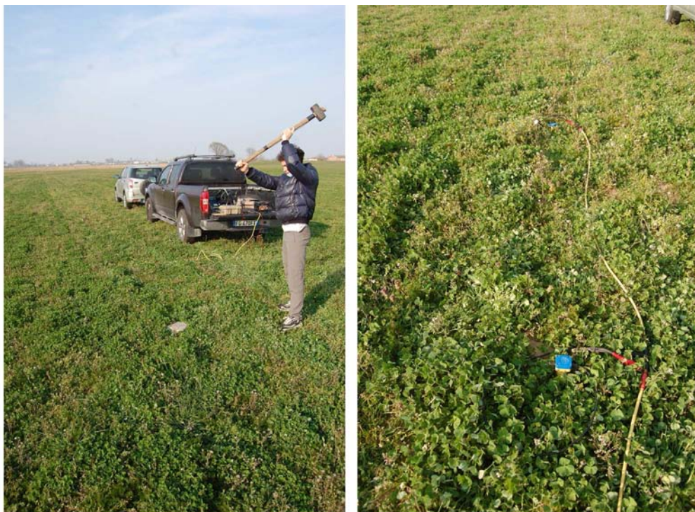
Particolare delle fasi di esecuzione della prova MASW
