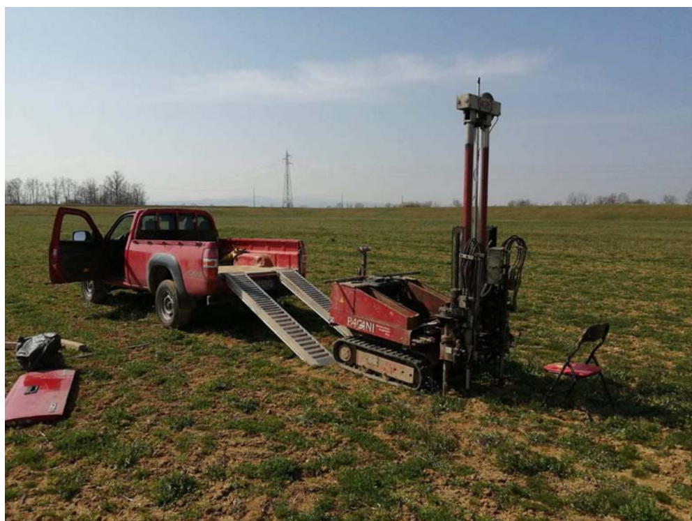
Fasi dell'esecuzione della prova CPT4
