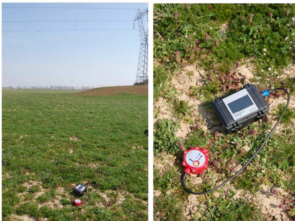
A sinistra l'ubicazione della prova HVSR in riferimento alla prova CPT3
