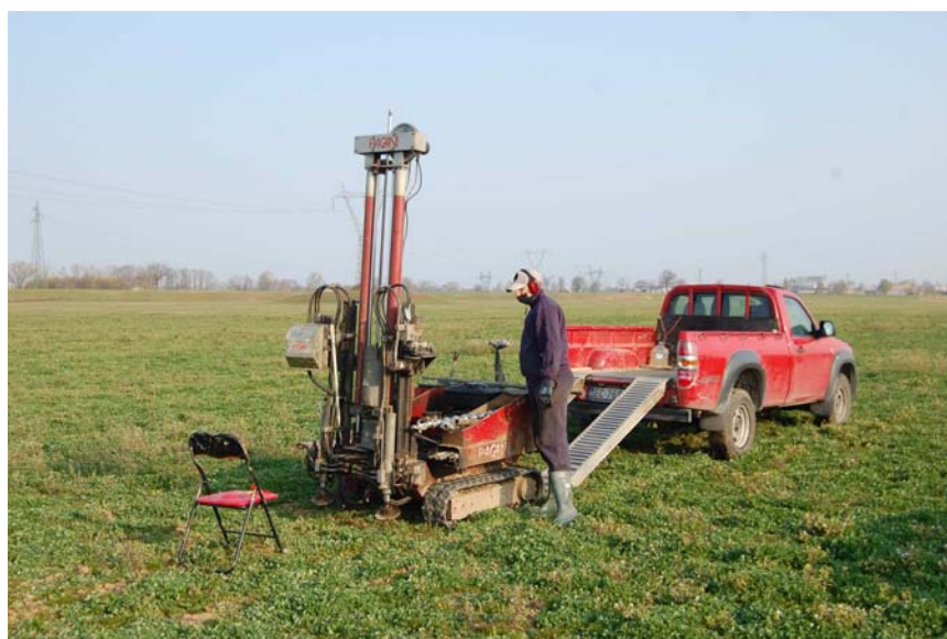
Fasi dell'esecuzione della prova CPT1
