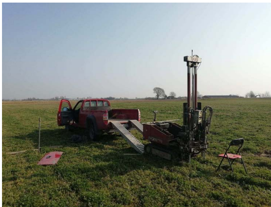
Fasi dell'esecuzione della prova CPT2
