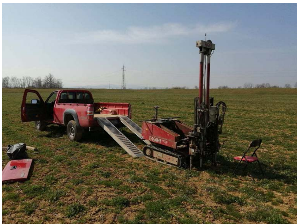
Fasi dell'esecuzione della prova CPT4
