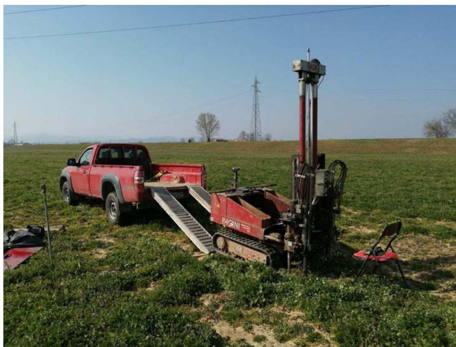
Fasi dell'esecuzione della prova CPT3
