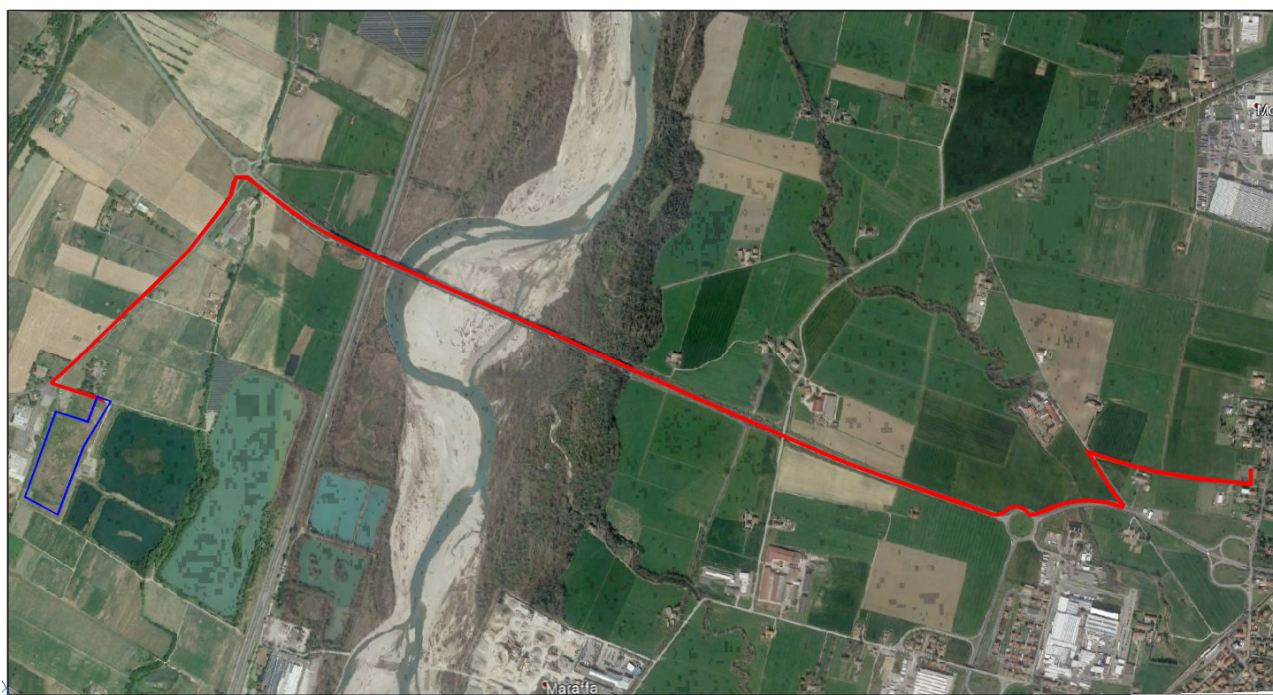
Figura 2 – Inquadramento dell'area di intervento su foto aerea (Fonte Google earth, immagine del 18/03/2020). In blu l'area in cui si prevede la realizzazione dell'impianto fotovoltaico, in giallo il tracciato della linea elettrica di connessione interrata, in rosso il tracciato della linea area staffata alle strutture del ponte.
