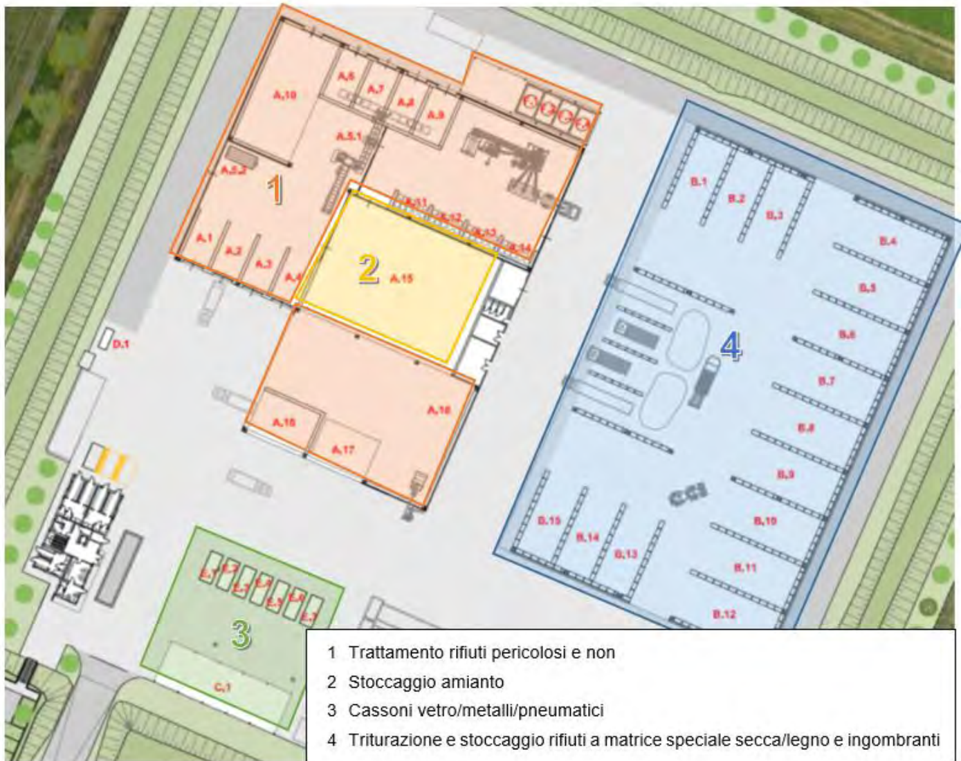
Figura 2. Aree tecnico-funzionali polo impiantistico di Mezzani (da "Relazione generale illustrativa –progetto definitivo")
