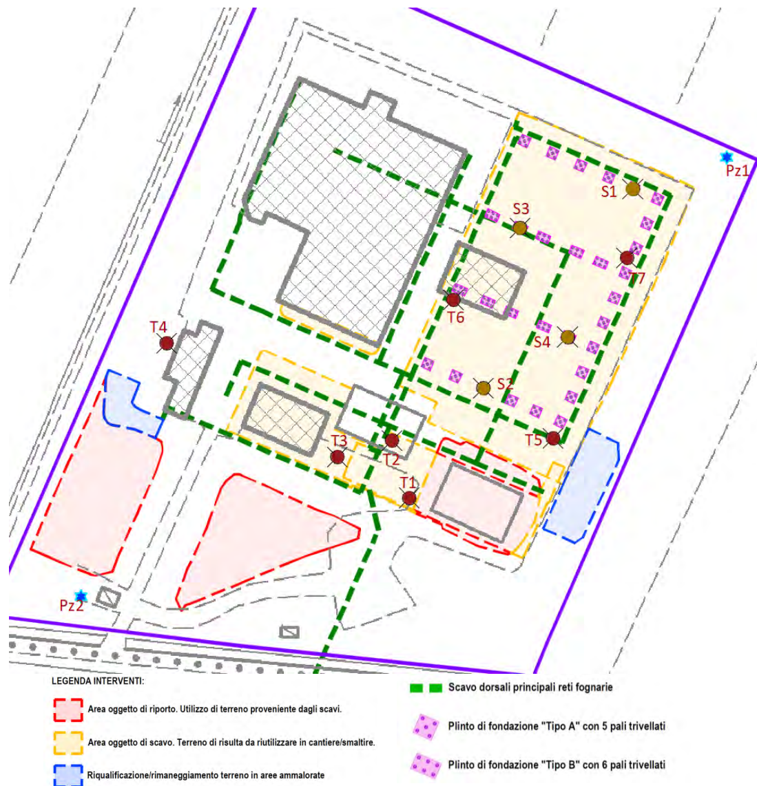
Figura 41. Ubicazione delle verticali di campionamento su base planimetria scavi-riporti.
