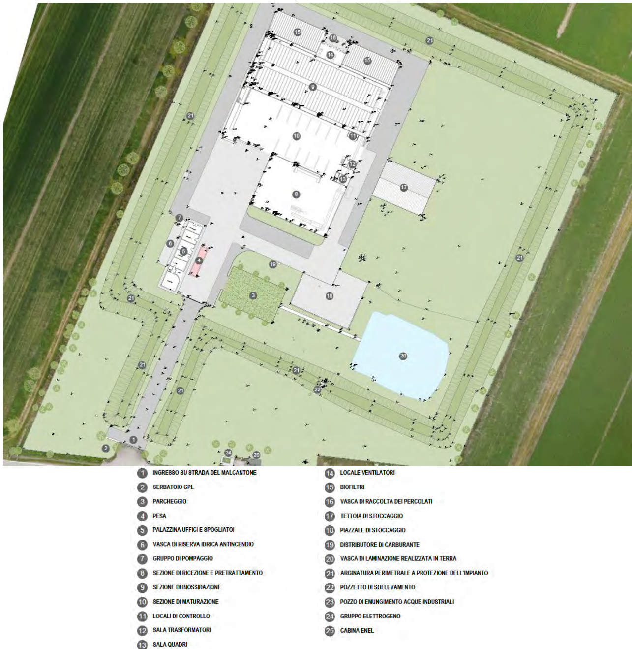
Figura 1. Estratto da elaborato ARC09_ Planimetria generale dello stato di fatto.
