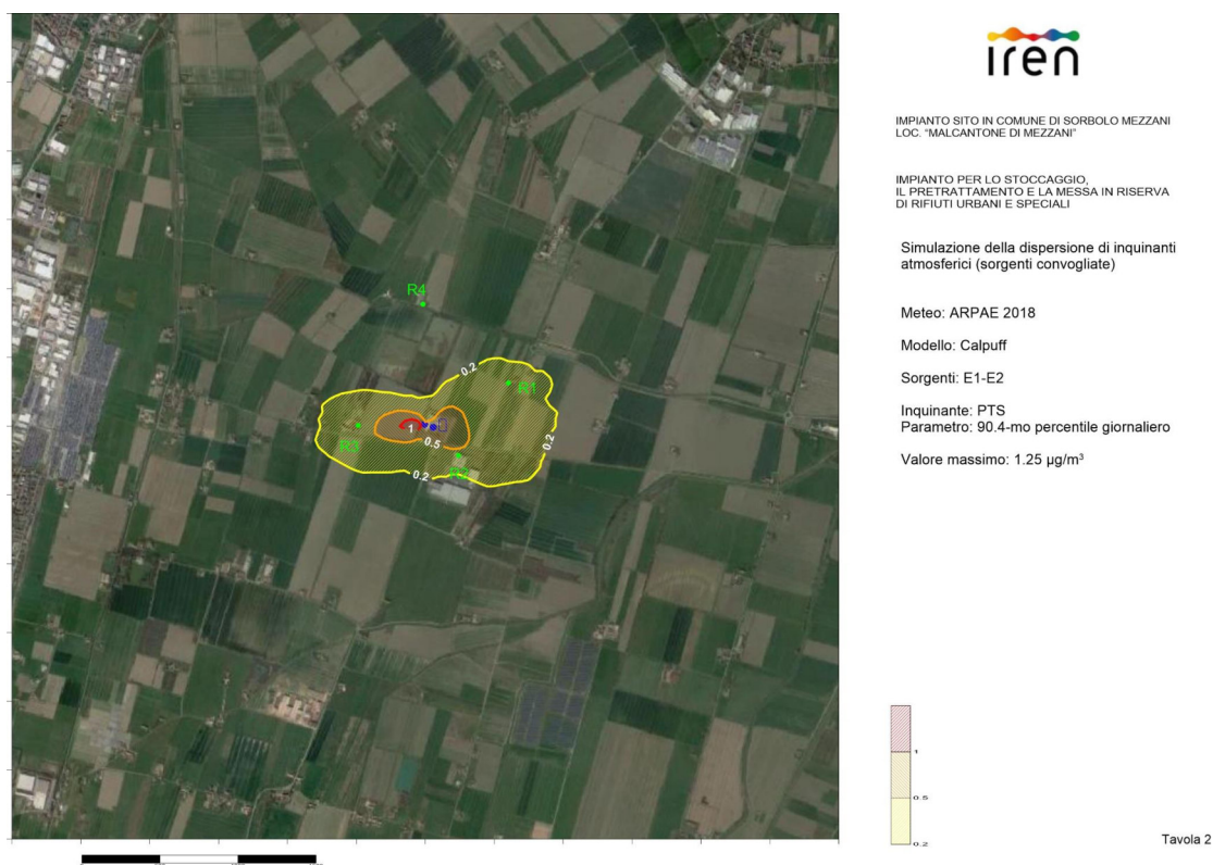
Figura 30: Simulazione della dispersione delle PTS
