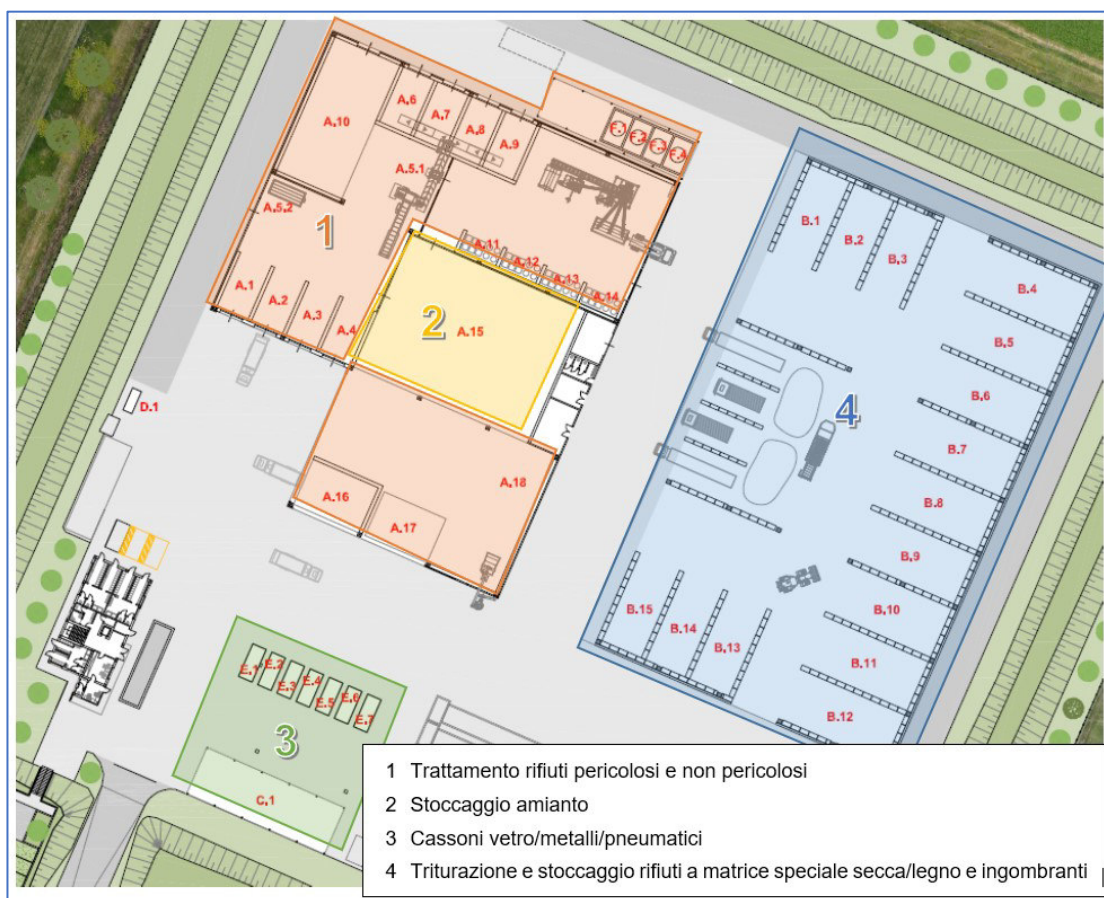
Figura 7: Polo impiantistico di Mezzani Schema layout di progetto
