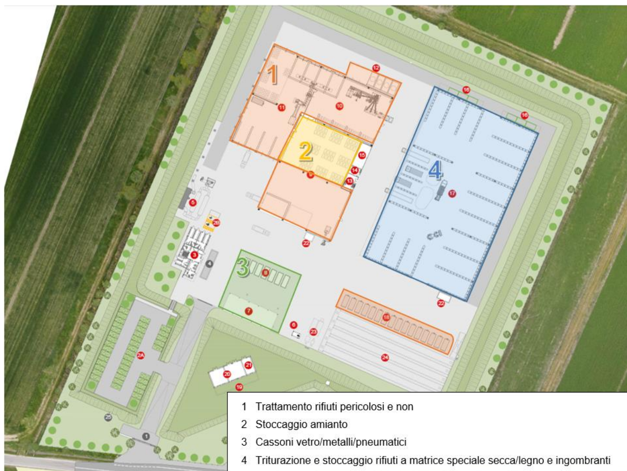
Figura 3 - sistema impiantistico sito Mezzani
