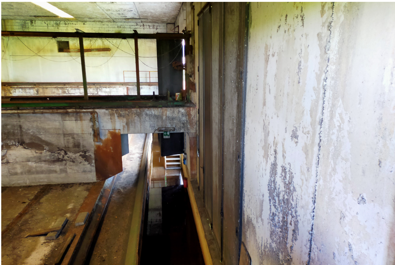
IMMAGINE 6 - Vista dall'alto della fossa di carico del nastro che trasporta il materiale dalla sezione di bioossidazione alla sezione di maturazione
