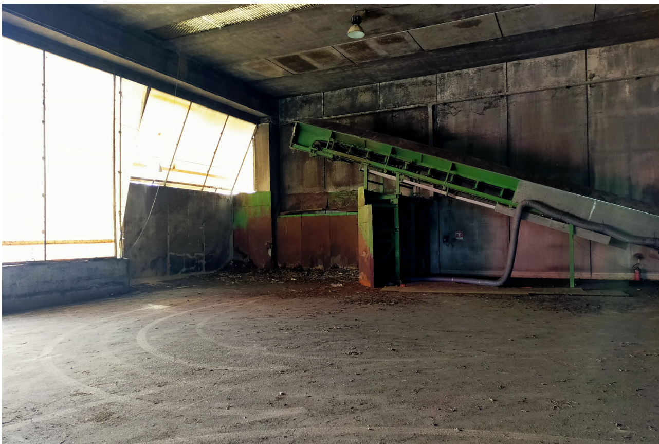
IMMAGINE 5 - Vista della baia di scarico del materiale biostabilizzato diretto a maturazione
