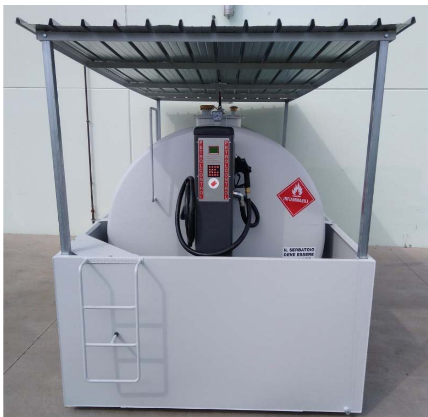
Fig.12.: Serbatoio carburante con colonnina di distribuzione, vasca per il contenimento di eventuali sversamenti e tettoia metallica di copertura
