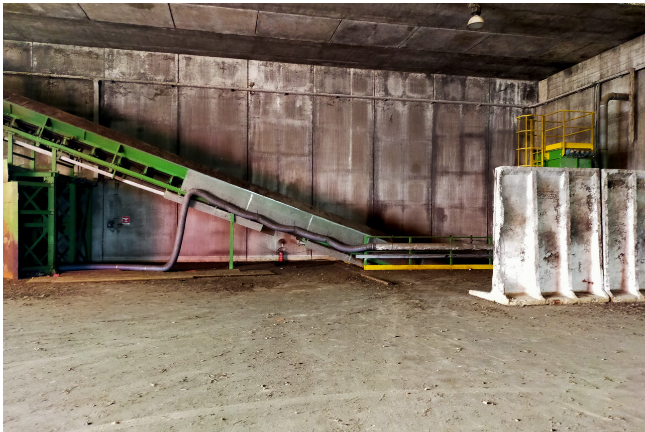
IMMAGINE 4 - Vista del nastro che trasporta il materiale biostabilizzato alla sezione di maturazione
