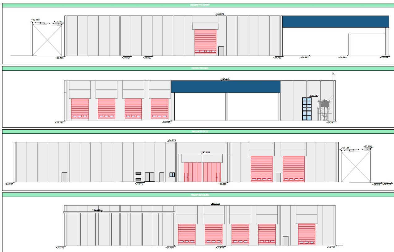
Fig.17.: Prospetti del capannone - configurazione di progetto
