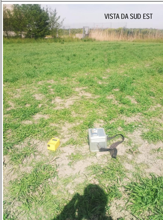
Postazione misurazione rumore sismico ambientale a stazione singola con tecnica HVSR
