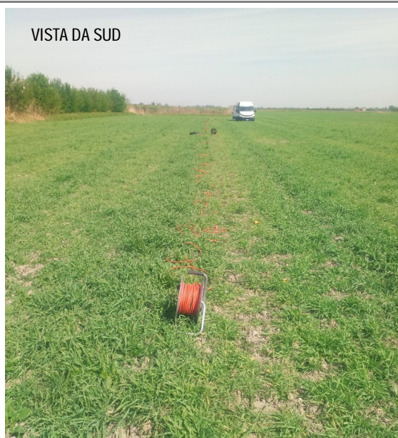
Postazione stendimento sismico MASW
