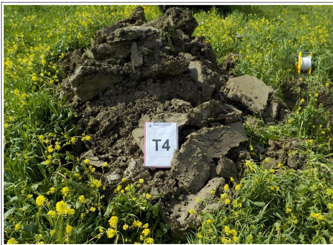
DETTAGLIO DEL MATERIALE ESCAVATO RIFERIBILE ALL'UNITÀ "A"
