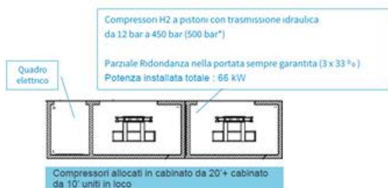
Figura 5. Configurazione tipica del container "compressione"(immagine esemplificativa)
