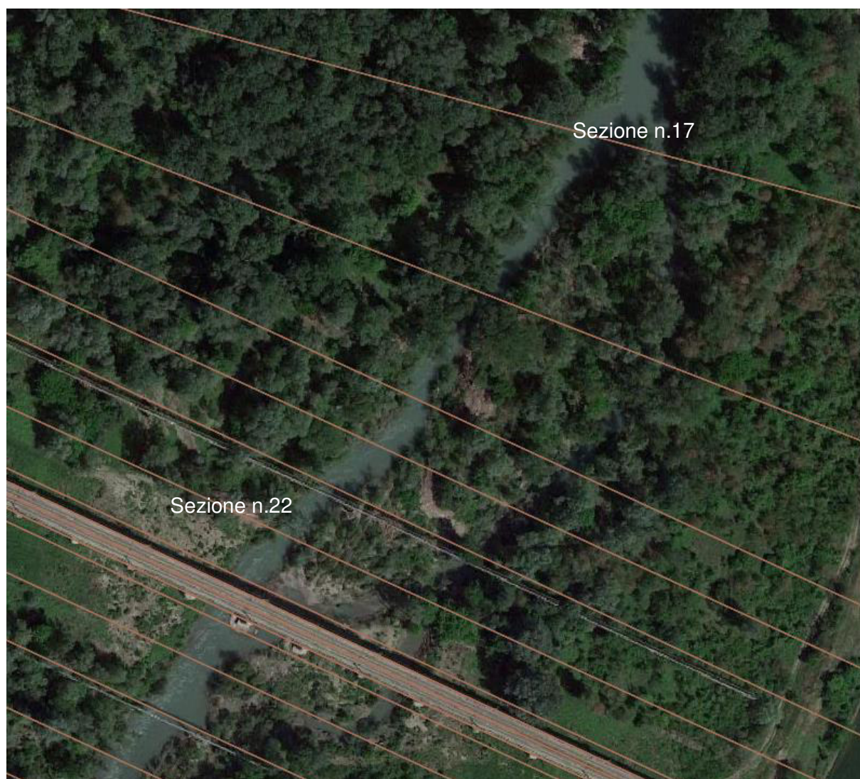
Figura 5.4: Sezioni con biforcazione dell'alveo
