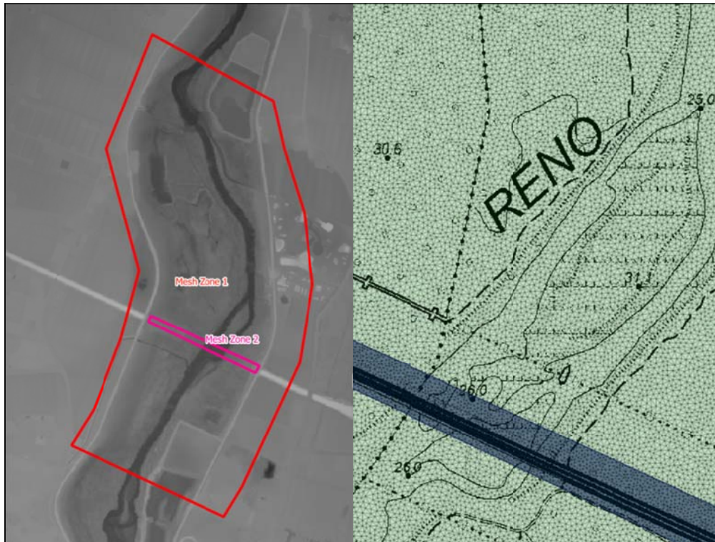
Figura 31 A sinistra dominio e zone a mesh più fitta. A destra porzione di dominio con zone a differente mesh in verde più rada, in blu più fitta
