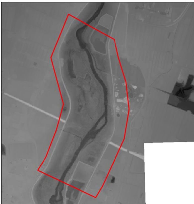
Figura 30 LIDAR utilizzato nella modellazione bidimensionale. In rosso evidenziato il dominio di calcolo del modello bidimensionale.
