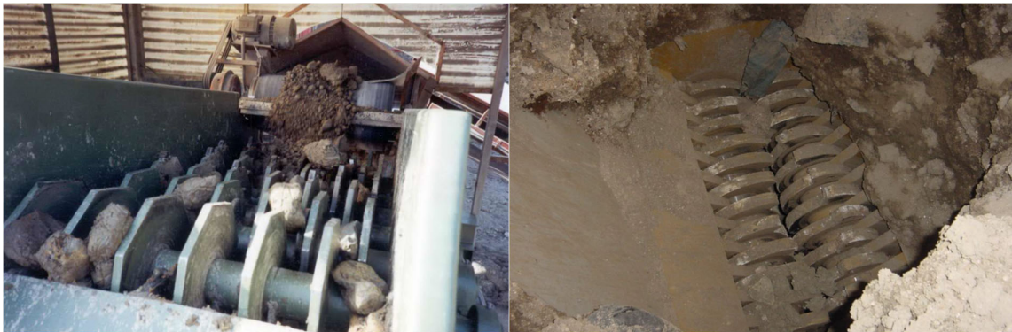
Figura 5.1 – Esempio di griglia a dischi (sinistra) e di trituratore a dischi (destra).
