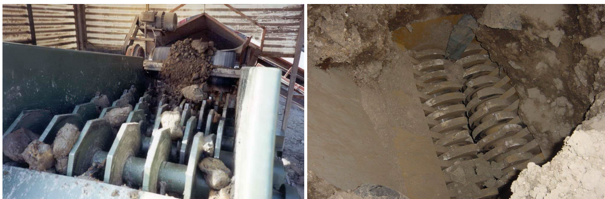
Figura 48 - Esempio di griglia a dischi (sinistra) e di tritratore a dischi (destra).
