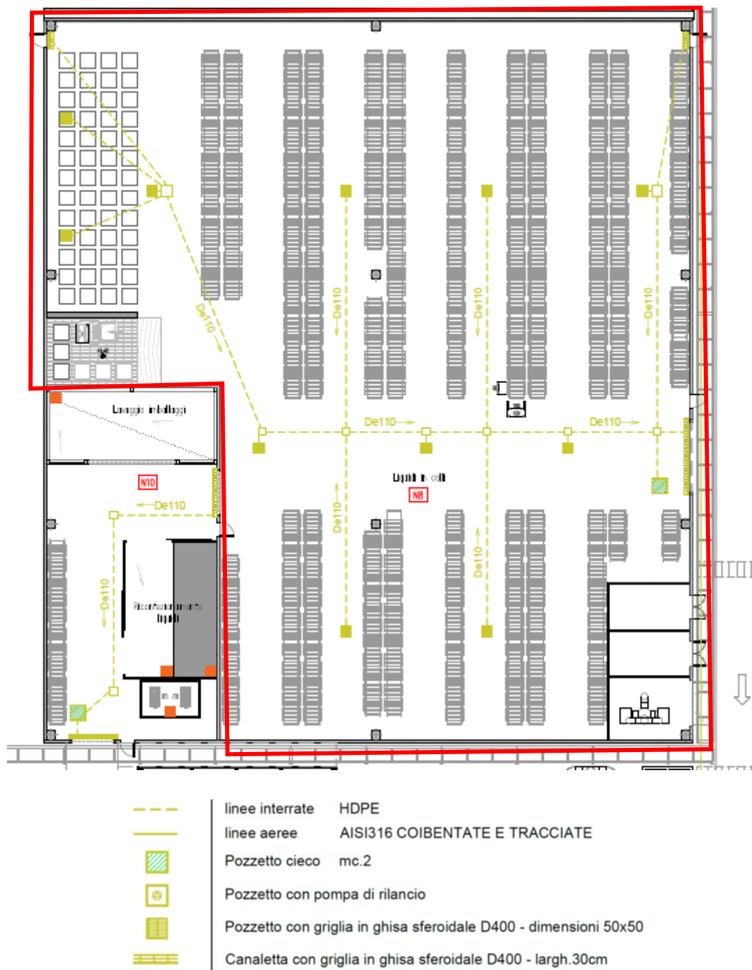
Figura 28 – Dettaglio rete di drenaggio sezione N8 (stralcio elaborato CO 05 RA AA 01 DT PL 03.02 – Allegato 3B – Planimetria dell'impianto (rete idrica))
