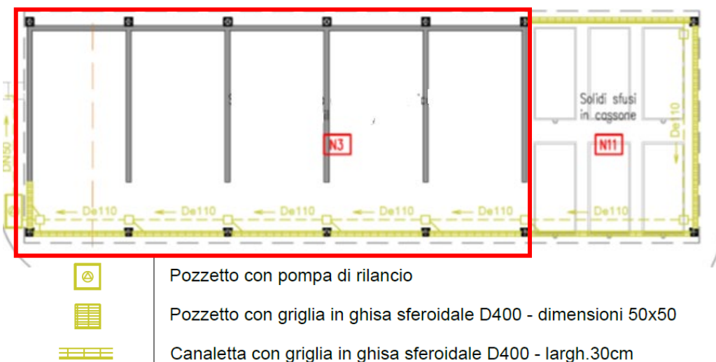
Figura 18 – Dettaglio rete di drenaggio sezione N3 ed N11 (stralcio elaborato CO 05 RA AA 01 DT PL 03.02 – Allegato 3B – Planimetria dell'impianto (rete idrica)
