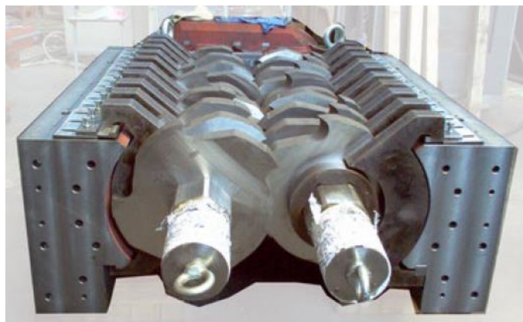
Figura 6 – Camera di triturazione, sezione esemplificativa del profilo curvo dell'alloggiamento degli alberi porta-lame
