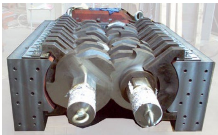
Figura 3 – Camera di triturazione, sezione esemplificativa del profilo curvo dell'alloggiamento degli alberi porta-lame
