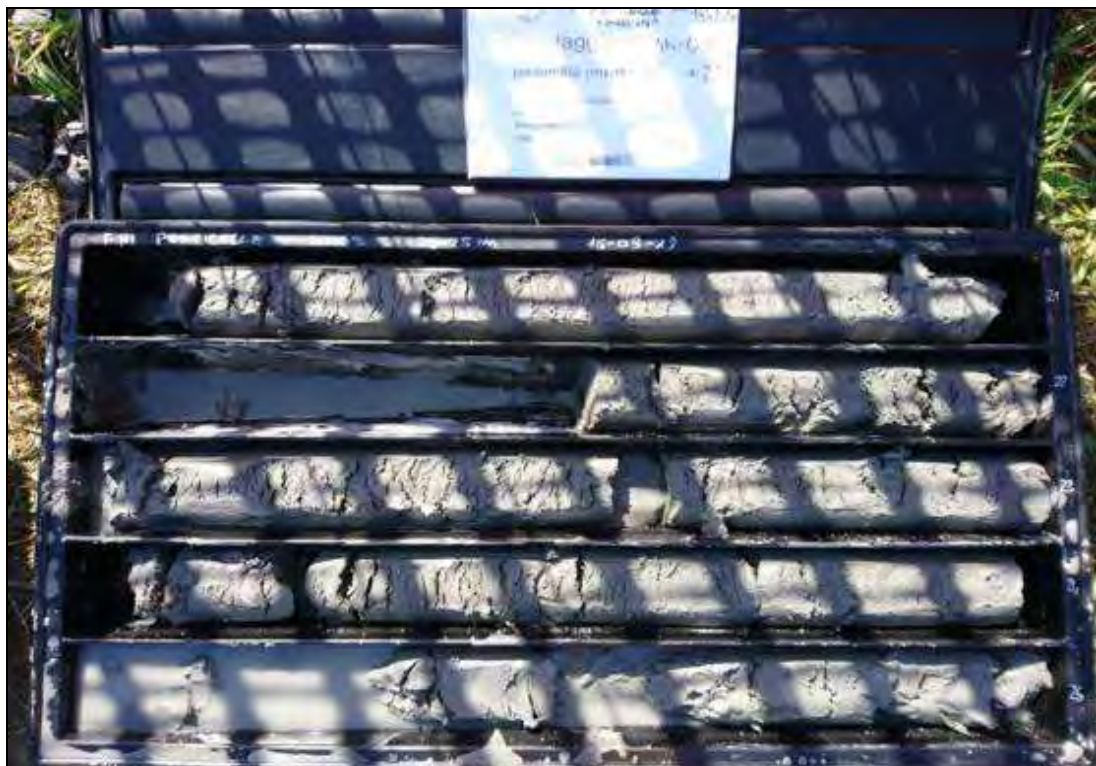
Fig. 25. Carote del tratto compreso tra 20,0m e 25,0m da p.c. del sondaggio BH-03. Vuoto tra 21,0m - 21,5m per prelievo campione indisturbat BH_03 Sh 2.
