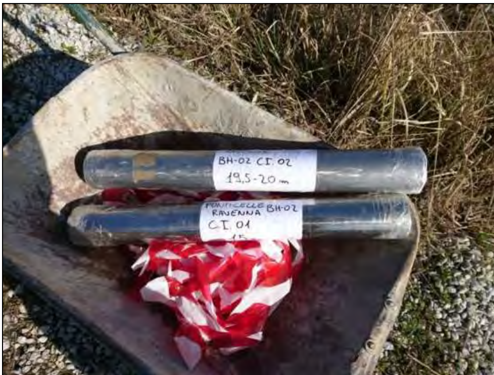
Fig. 18. Campioni indisturbati di tipo Shelby (Sh-01, Sh-02) prelevati durante il sondaggio BH-02.
