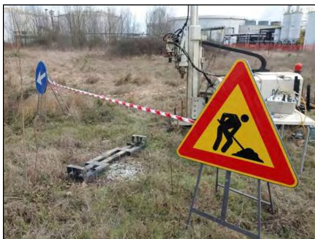
Fig. 31.. Esecuzione della prova CPTU-02, piazzamento della sonda (Geoprobe Gaia), segnaletica di sicurezza e delimitazione dell'area con nastro B/R.
