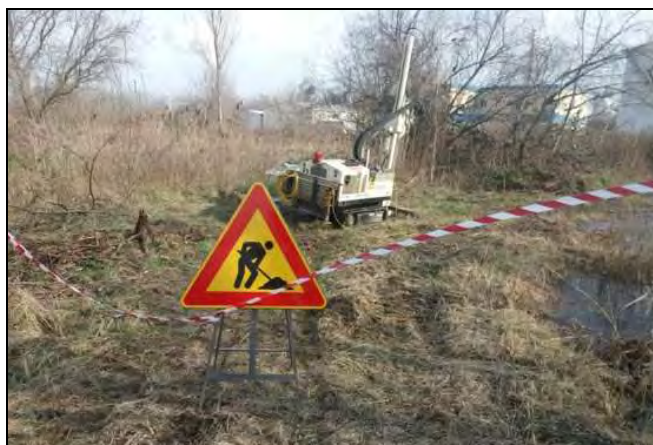
Fig. 32.. Esecuzione della prova CPTU-03, piazzamento della sonda (Geoprobe Gaia) segnaletica di sicurezza e delimitazione dell'area con nastro B/R.
