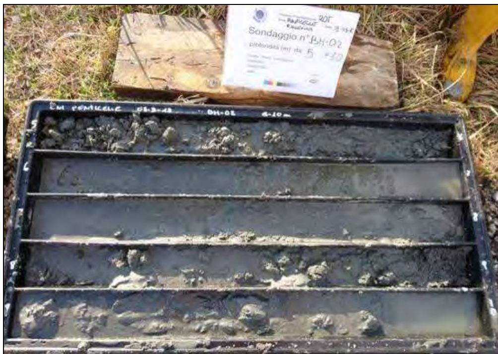
Fig. 12. Carote del tratto compreso tra 5,0m e 10,0m da p.c. del sondaggio BH-02.
