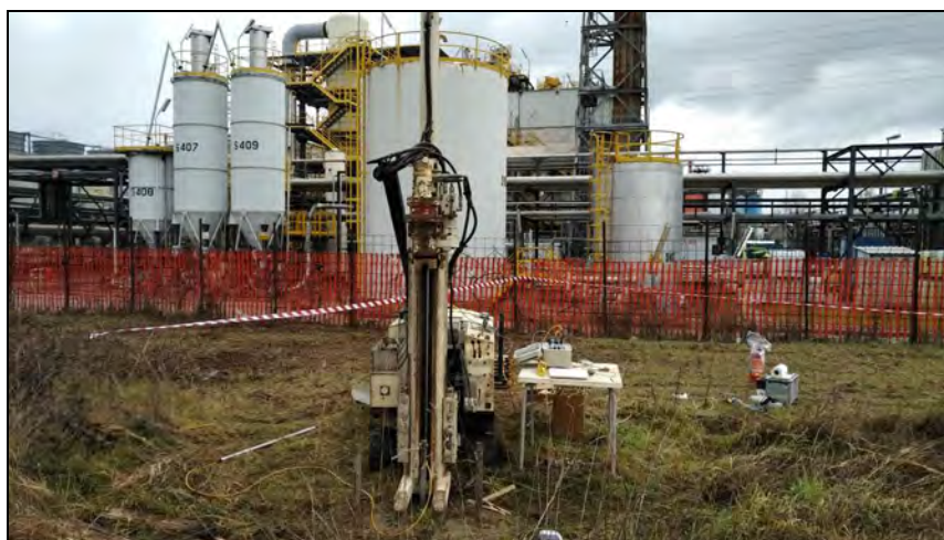
Fig. 35.. Esecuzione della prova CPTU-07, piazzamento della sonda (Geoprobe Gaia) e delimitazione dell'area con nastro B/R.
