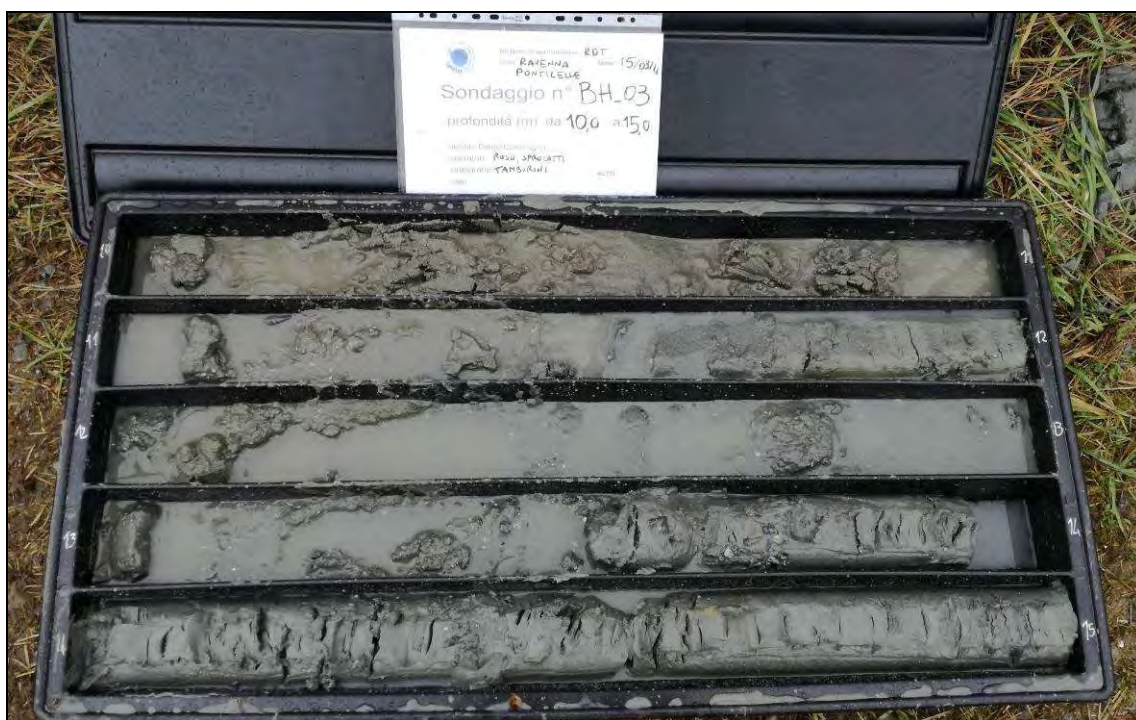
Fig. 23. Carote del tratto compreso tra 10,0m e 15,0m da p.c. del sondaggio BH-03.
