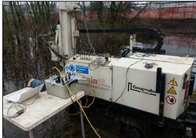
Fig. 33.. Esecuzione della prova CPTU-05, piazzamento della sonda (Geoprobe Gaia).
