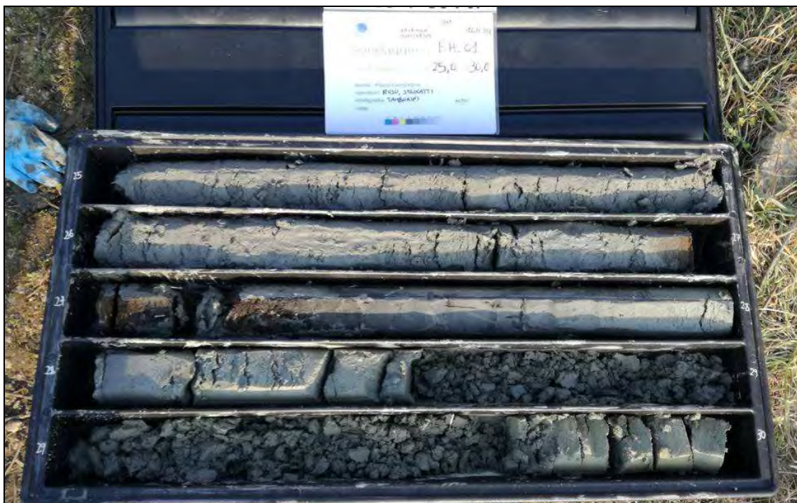
Fig. 7. Carote del tratto compreso tra 25,0m e 30,0m da p.c. del sondaggio BH-01.
