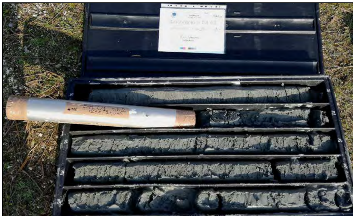
Fig. 6. Carote del tratto compreso tra 20,0m e 25,0m da p.c. del sondaggio BH-01. Campione indisturbato di tipo Shelby (BH-01 Sh2) prelevato tra 21,0m e 21,5m da p.c.
