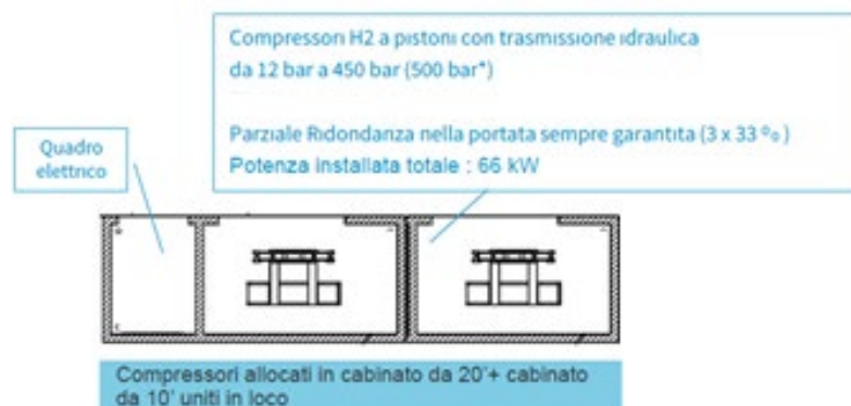
Figura 51. Configurazione tipica del container "compressione"(immagine esemplificativa)
