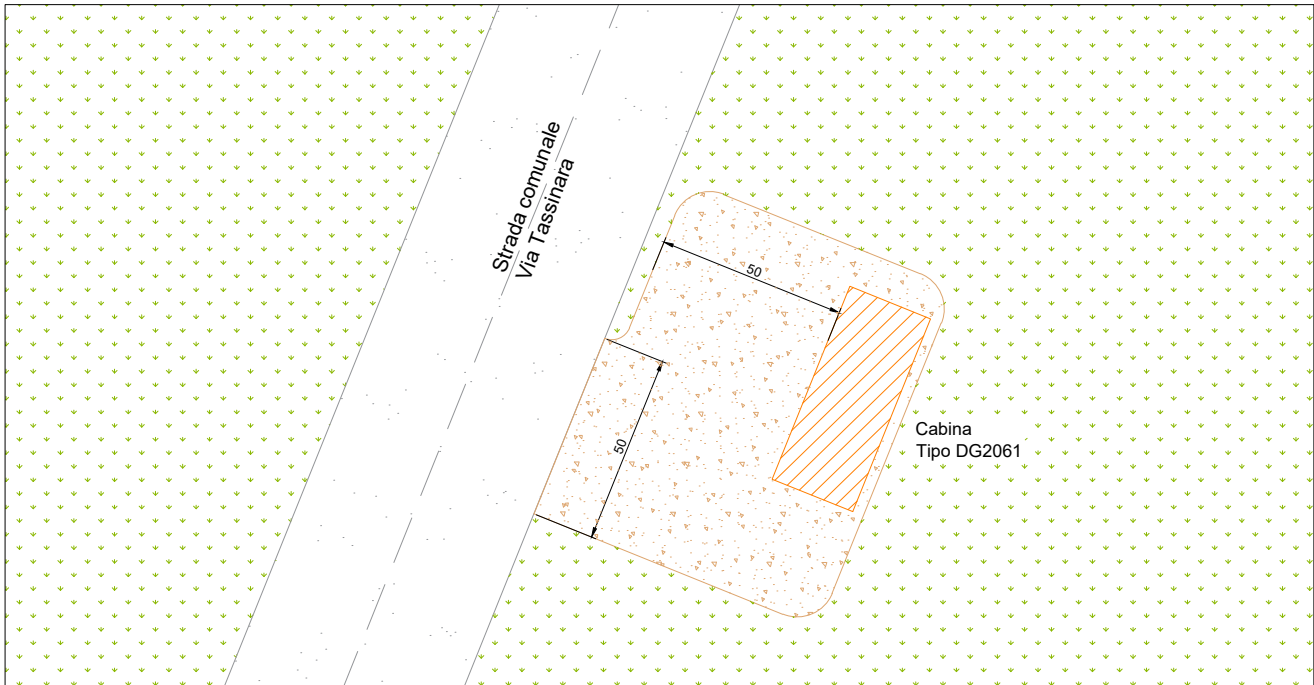
Cabina di sezionamento - standard e-distribuzione DG2061
