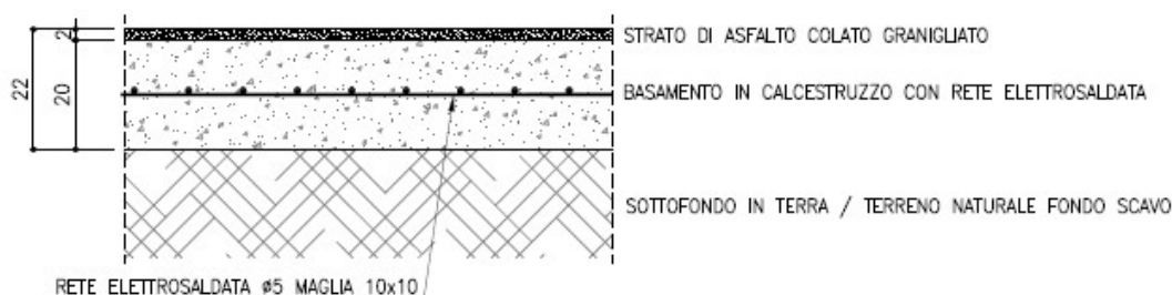
Figura 12-6. Composizione sovrastruttura marciapiede – TIPO P1F
