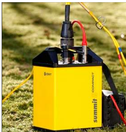
Fig. 2 – Sismografo 24 canali modello Compact.
