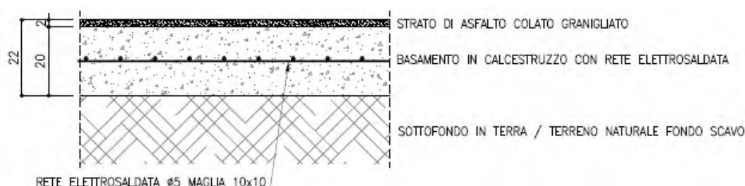
Figura 4-6. Composizione sovrastruttura marciapiede – TIPO P1F
