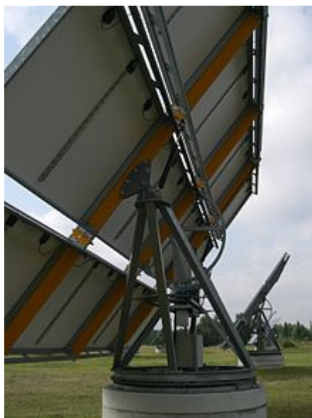
Figura 12: inseguitore a due gradi di libertà
