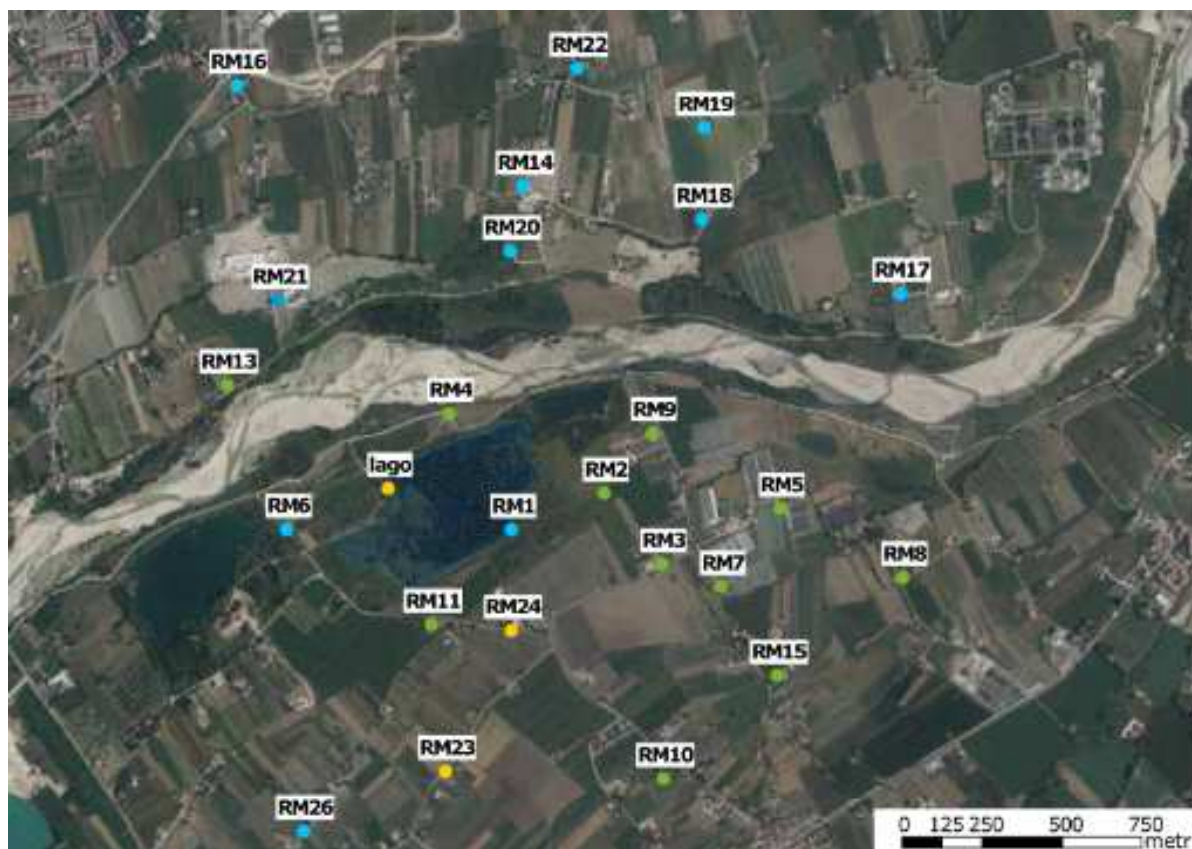
Figura 1: Rete di monitoraggio per la valutazione dell'efficacia della ricarica. In blu i punti per il monitoraggio del livello, in giallo i punti per il monitoraggio della qualità, in verde i punti per entrambi i monitoraggi. Con il puntinato azzurro il Lago In.Cal System. (Severi, et al., 2016)
