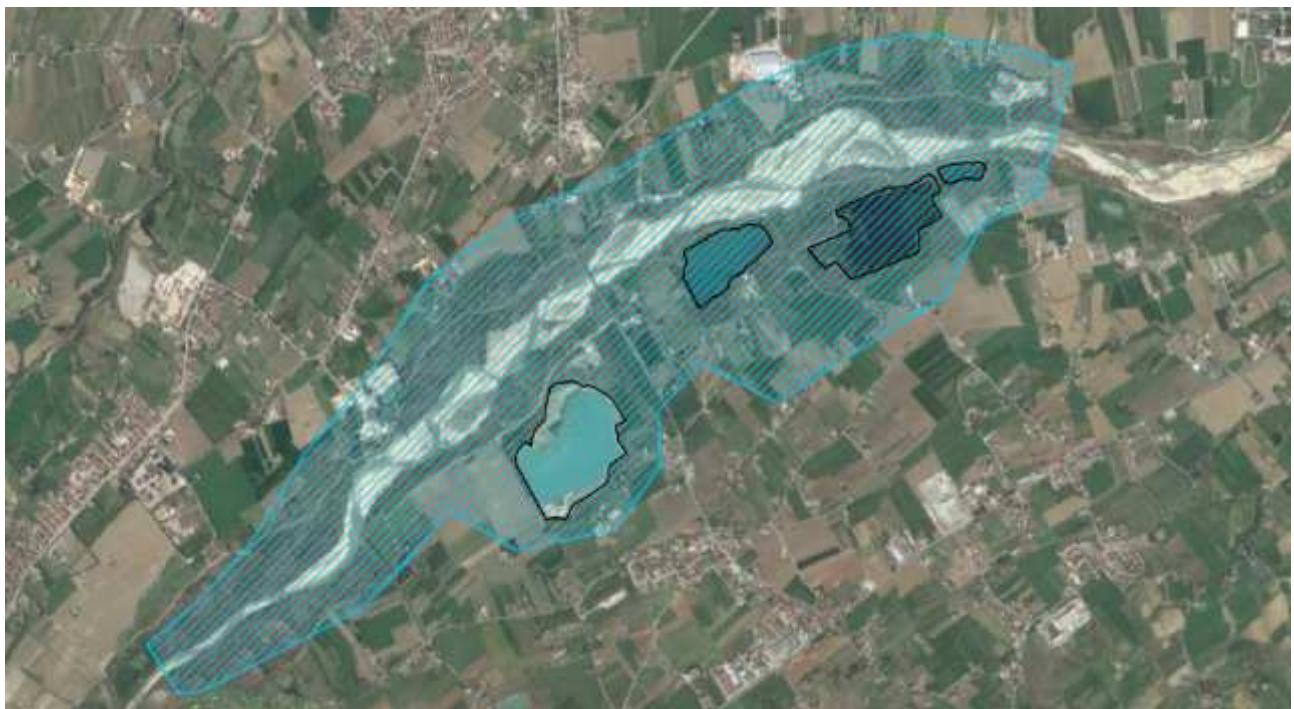
Figura 4: Perimetrazione dell'area 2D di calcolo usata nella simulazione, con indicazione del perimetro dei laghi in nero
