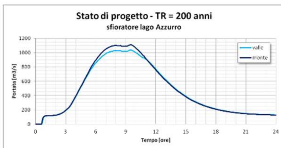
Figura B-5: dettaglio dell'effetto sulla laminazione dell'onda di piena in ingresso per TR=200 anni, relativamente allo sfioratore associato al lago Azzurro
