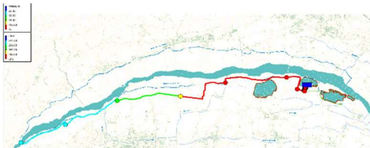
Figura B-2: Rappresentazione della rete di progetto - Schermata software EPANET
