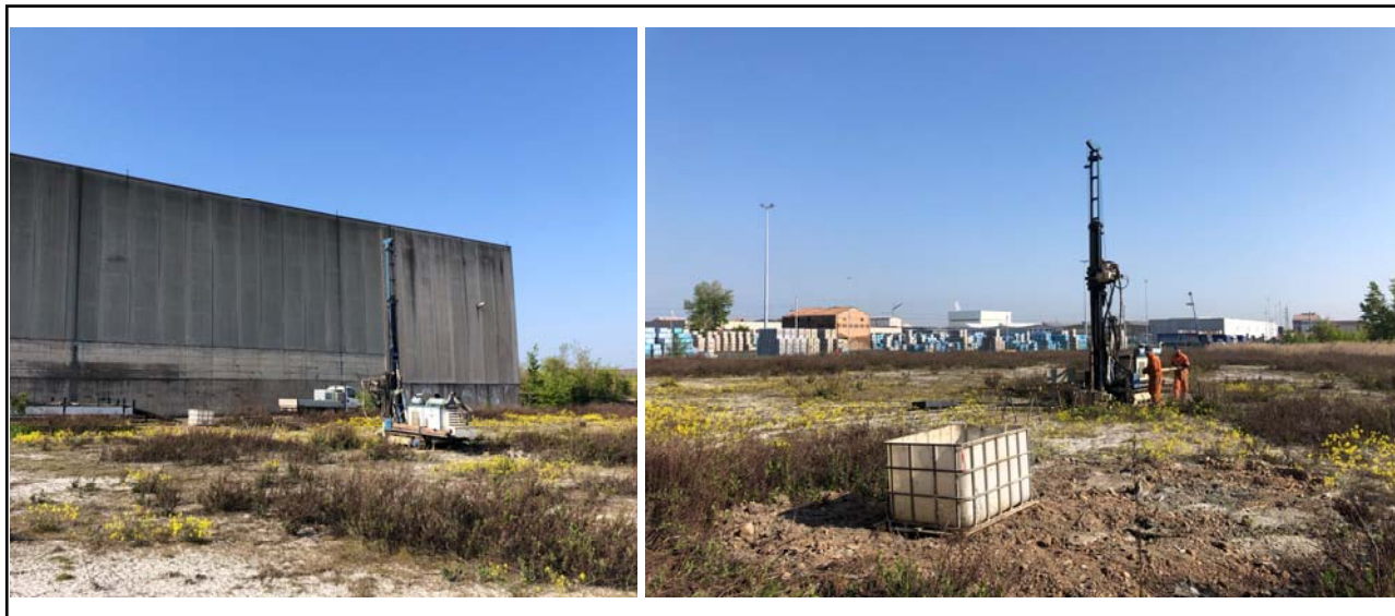
Fig. 1.5: Ubicazione del sondaggio a carotaggio continuo (23/04/2021).
