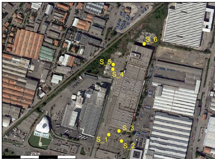
Figura 14 - Ubicazione saggi con escavatore meccanico (da: Relazione tecnico-ambientale inerente l'accertamento preliminare della matrice terreno presso l'area di proprietà Kerakoll in via Pedemontana in Comune di Sassuolo (MO), a cura di Geo Group s.r.l., maggio 2021)
