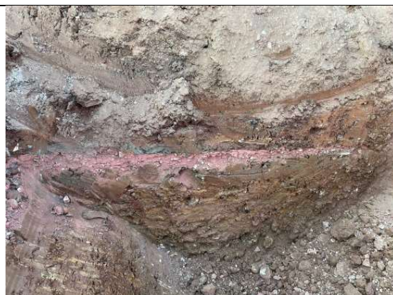
MISE 2021 – Strato di fanghi ceramici al di sotto della pavimentazione nella zona nord-ovest del capannone.
