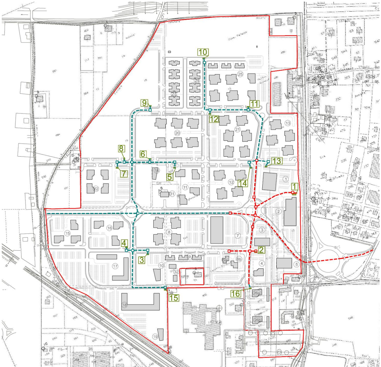
Figura 70 Schema impianti distribuzione energia elettrica MT
