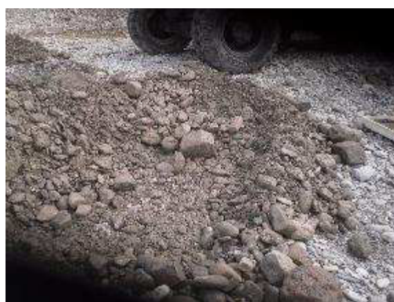
Fig. 21 Trincea T3 e campioni T3c1 e T3c2 (Acqua a -0,90m)
