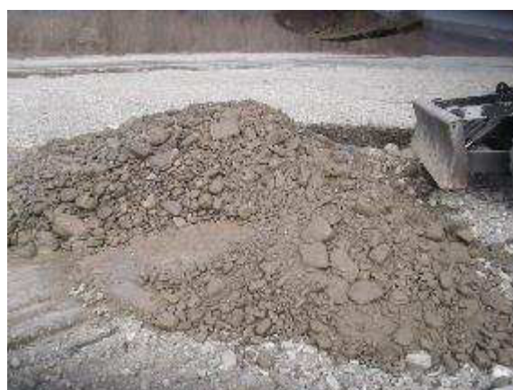
Fig. 19 Trincea T1 e campioni T1c1 e T1c2 (Acqua a -1,40m)
