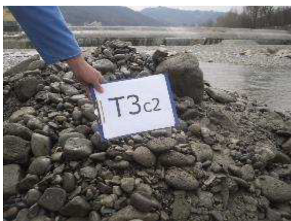
Fig. 21 Trincea T3 e campioni T3c1 e T3c2 (Acqua a -0,90m)
