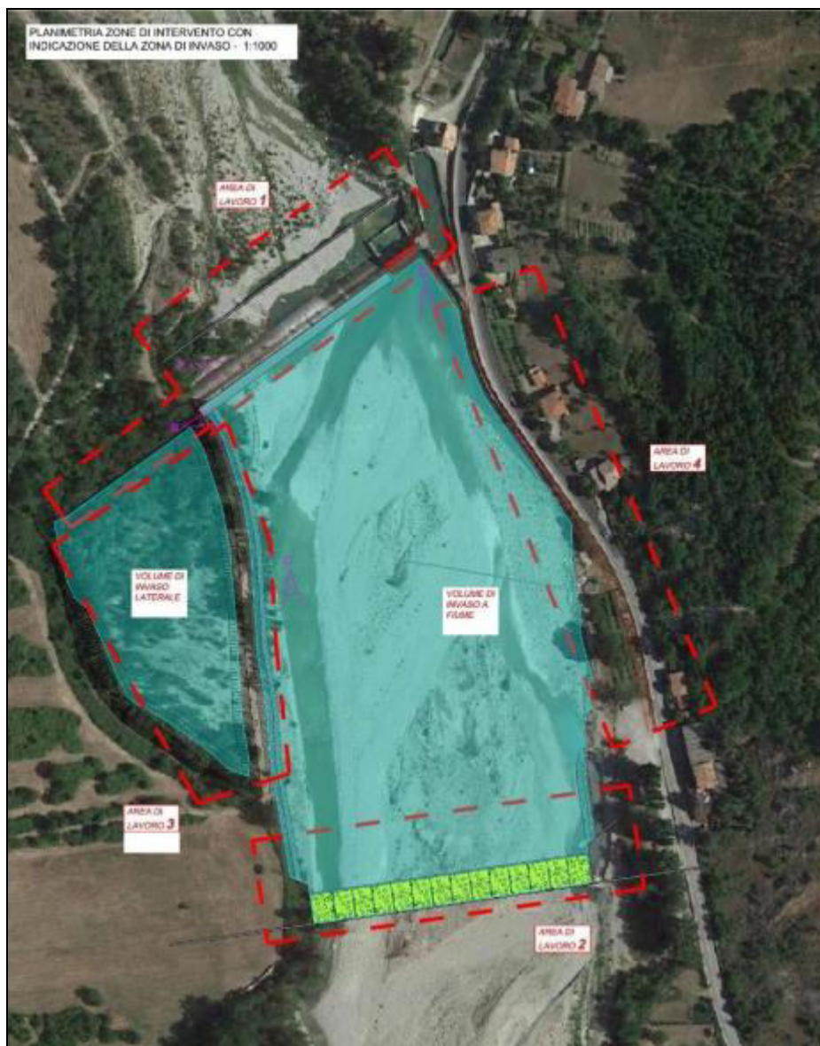
Figura 9.5 - Planimetria della zona di intervento con indicazione della zona di invaso e delle singole aree di lavoro
