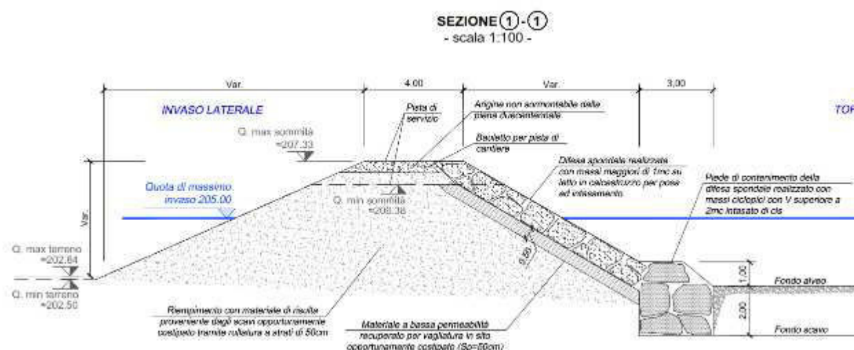
Fig 24 Sezione argine divisorio tra invaso a fiume ed invaso laterale
