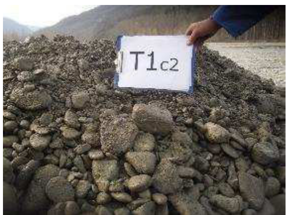
Fig. 19 Trincea T1 e campioni T1c1 e T1c2 (Acqua a -1,40m)
