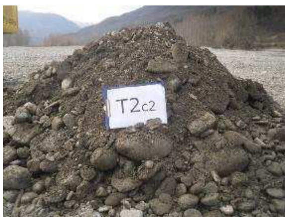
Fig. 20 Trincea T2 e campioni T2c1 e T2c2 (Acqua a -1,60m)
