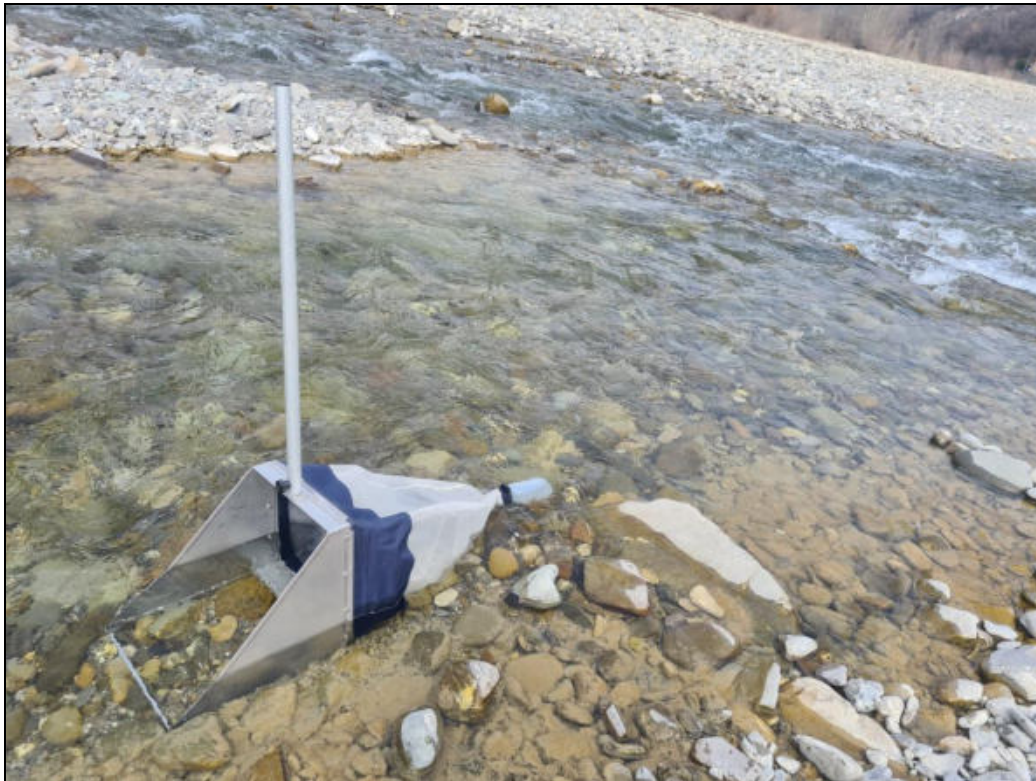
Figura 4.1: monitoraggio della cenosi a macroinvertebrati bentonici mediante l'ausilio del retino Surber. Foto scattata il 02 marzo 2022 durante i monitoraggi di magra lungo il Torrente Enza.
