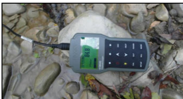
Figura 1.2: rilevamento dei principali parametri chimico-fisici dell'acqua (immagine di una fase marzo 2022)
