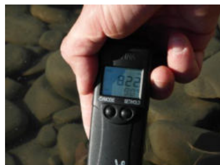
Figura 1.2: rilevamento dei principali parametri chimico-fisici dell'acqua (immagine di una fase marzo 2022)
