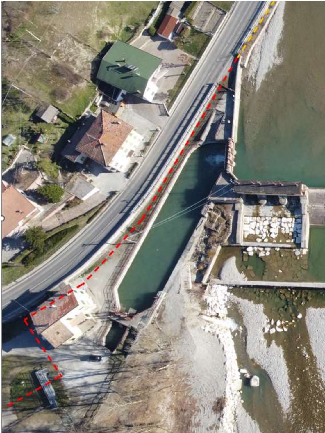
Figura 23: tracciato planimetrico servizi ireti – in giallo tratto all'interno del bauletto in rosso tratto interrato in area cortiliva CBEC
