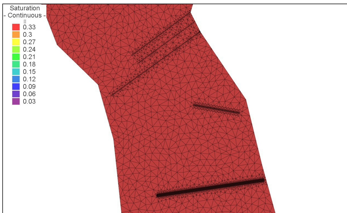
Figura 18. Porzione dello strato contenente il galleria drenante gestita da IREN, al centro dell'immagine, al tempo di simulazione t = 365 giorni. In alto le tracce delle fondazioni del manufatto, in basso quelle della soglia di monte. Tutto l'ammasso permeabile costituente il dominio, galleria drenante compresa, è generalmente saturo.
