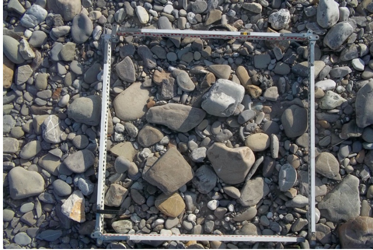
Figura 4. Rilievo e campionamento del materiale d'alveo sul torrente Enza a Cerezzola (Reggio Emilia) con specifica attenzione al materiale superficiale e all'azione di corazzamento da esso svolto.
