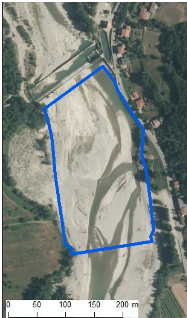
Figura 3. L'area del nuovo serbatoio che verrà attraversata dall'alveo attivo nei periodi in cui l'opera di sbarramento in progetto sarà abbattuta. Le tensioni tangenziali riportate in Tabella 3 sono calcolate all'interno del perimetro blu.
