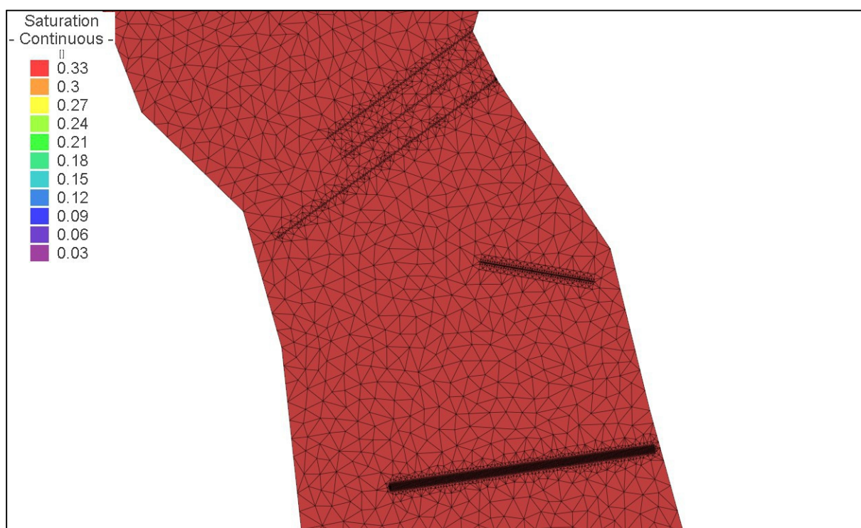
Figura 22. Porzione dello strato contenente la galleria drenante gestita da IREN, al centro dell'immagine, al tempo di simulazione t = 365 giorni. In alto le tracce delle fondazioni del manufatto, in basso quelle della soglia di monte. Tutto l'ammasso permeabile costituente il dominio, galleria drenante compresa, è generalmente saturo.
