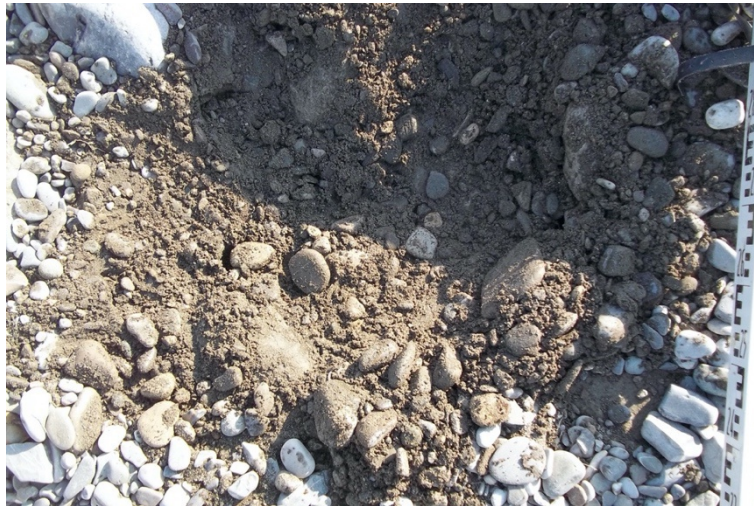
Figura 5. Rilievo e campionamento del materiale d'alveo sul torrente Enza a Cerezzola (Reggio Emilia) con specifica attenzione al materiale subsuperficiale presente nei primi 20–30 cm del profilo verticale. Le proprietà di tale materiale d'alveo è incorporata nella formula di Andrews.
