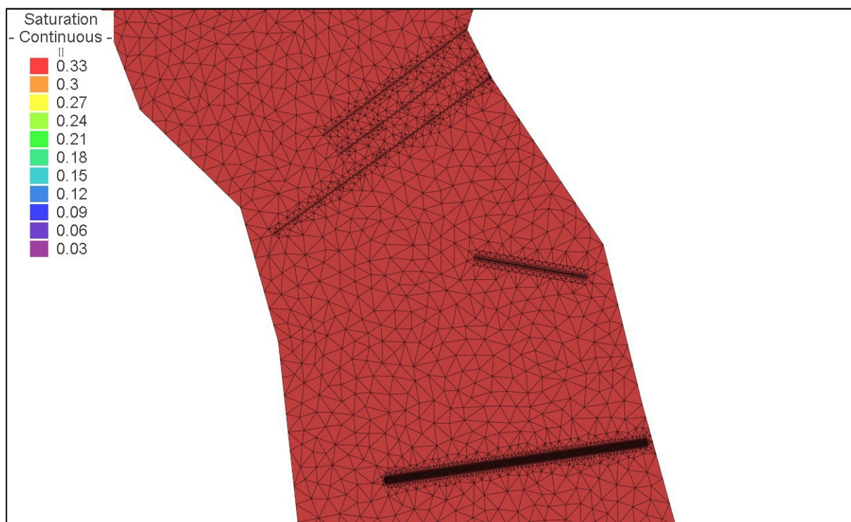
Figura 24. Porzione dello strato contenente la galleria drenante gestita da IREN, al centro dell'immagine, al tempo di simulazione t = 365 giorni. In alto le tracce delle fondazioni del manufatto, in basso quelle della soglia di monte. Tutto l'ammasso permeabile costituente il dominio, galleria drenante compresa, è generalmente saturo.
